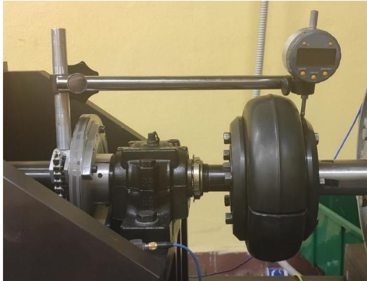
**Figura 2.14** Modulo di allineamento
