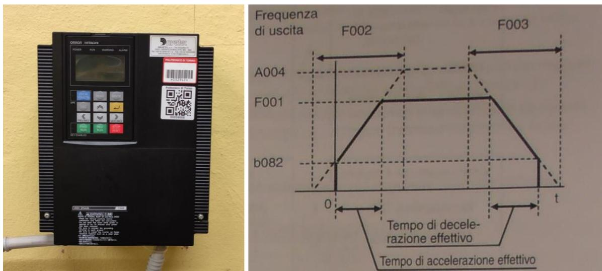
**Figura 3.4:** Inverter (a sinistra) e grafico per la programmazione delle rampe (a destra)
