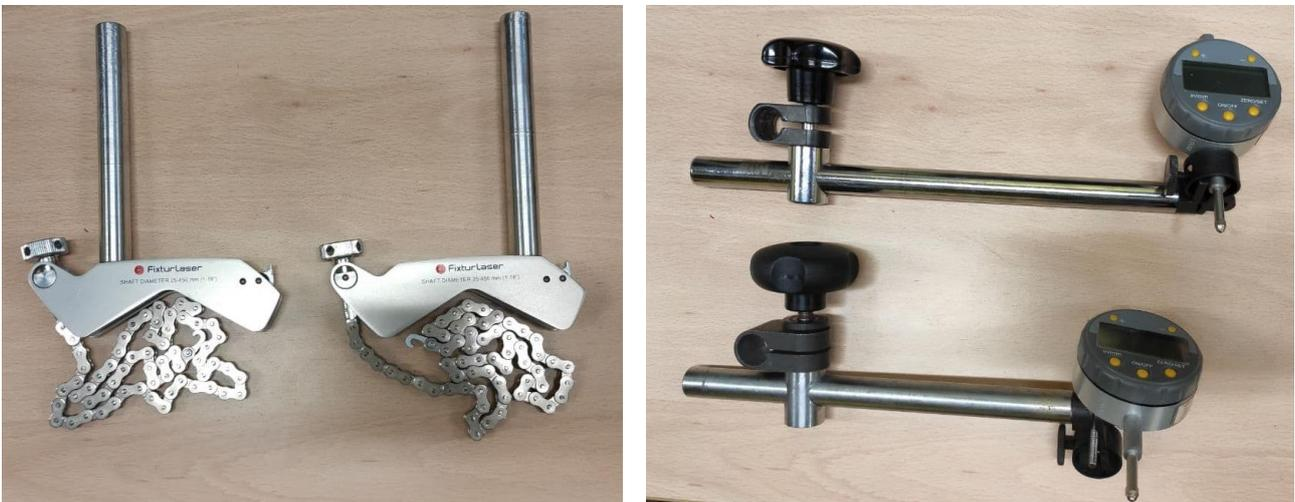
**Figura 4.1:** Staffe di fissaggio (destra), aste di supporto e comparatori (sinistra)
