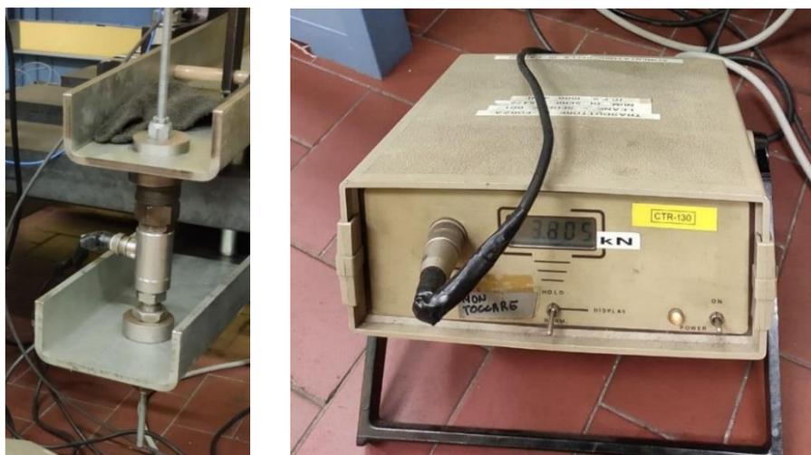
**Figura 3.6:** cella di carico (a sinistra) e suo alimentatore (a destra)
