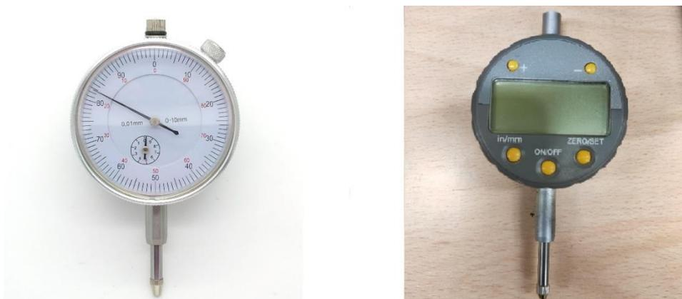
**Figura 2.13:** Comparatore analogico (sinistra) e comparatore digitale (destra)
