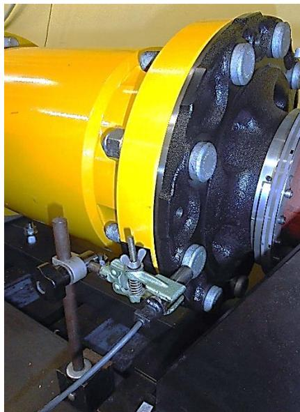
**Figura 3.5:** Sensore di prossimità (contagiri)
