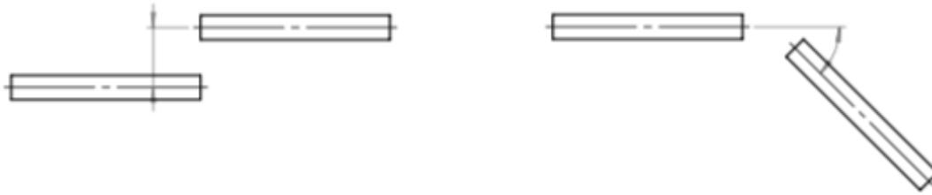
**Figura 2.1:** Disallineamento parallelo e disallineamento angolare
