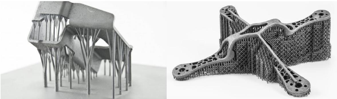
Figura 6. Supporti generati su componenti metallici mediante Software Materialise Magics® [12]
