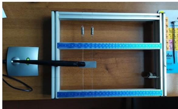
Figura 42. strumentazione IMCE per valutazione modulo elastico
