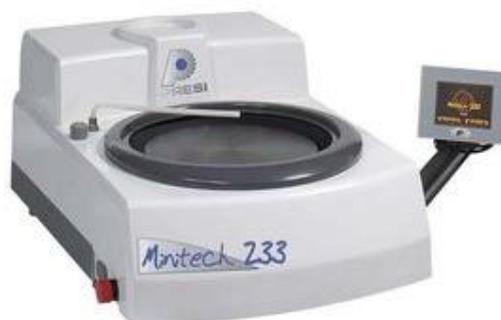
Figura 35. Macchinario per lucidatura Mecatech 233
