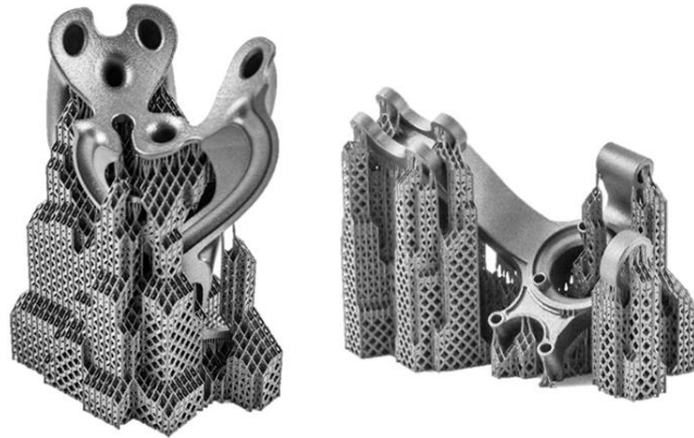
Figura 8. Esempio di supporti ottimizzati tramite software di design specifico [16]
