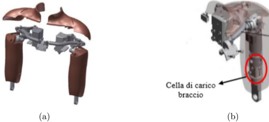
Figura 2.24: (a) arti superiori, spalle e clavicola e (b) posizione della cella di carico nel braccio.
