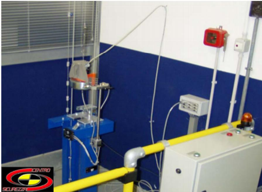
Figura 4.1: dispositivo “Drop rig”.
