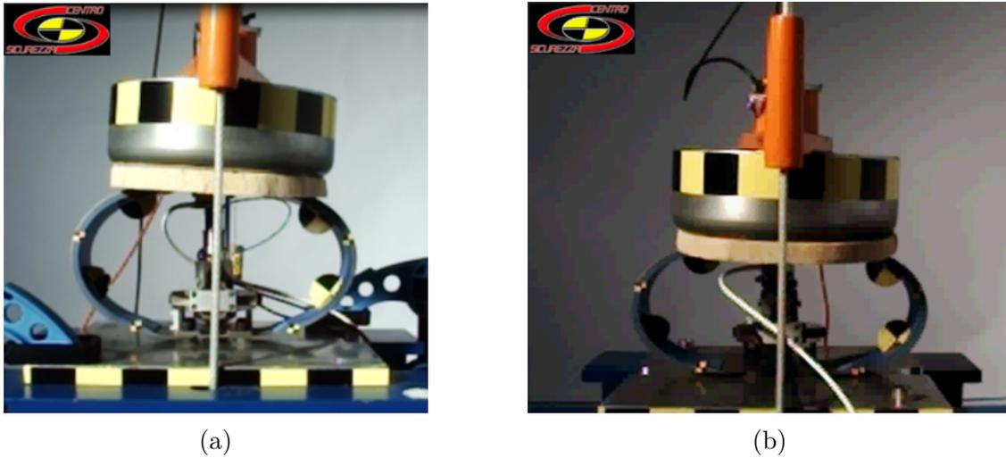
Figura 4.21: Frame di prova del sensore (a) IR-TRACC e (b) S-TRACK a 0° e altezza 400 mm
