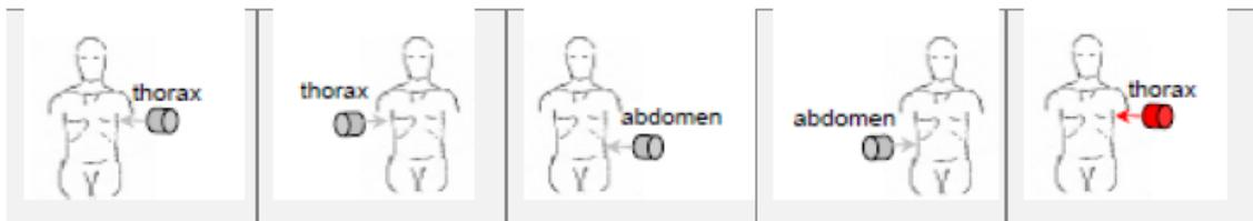
3° TEST: 5 test eseguiti sullo stesso PMHS: i primi tre a bassa velocità (1.5 m/s) e gli altri due a velocità maggiore.
