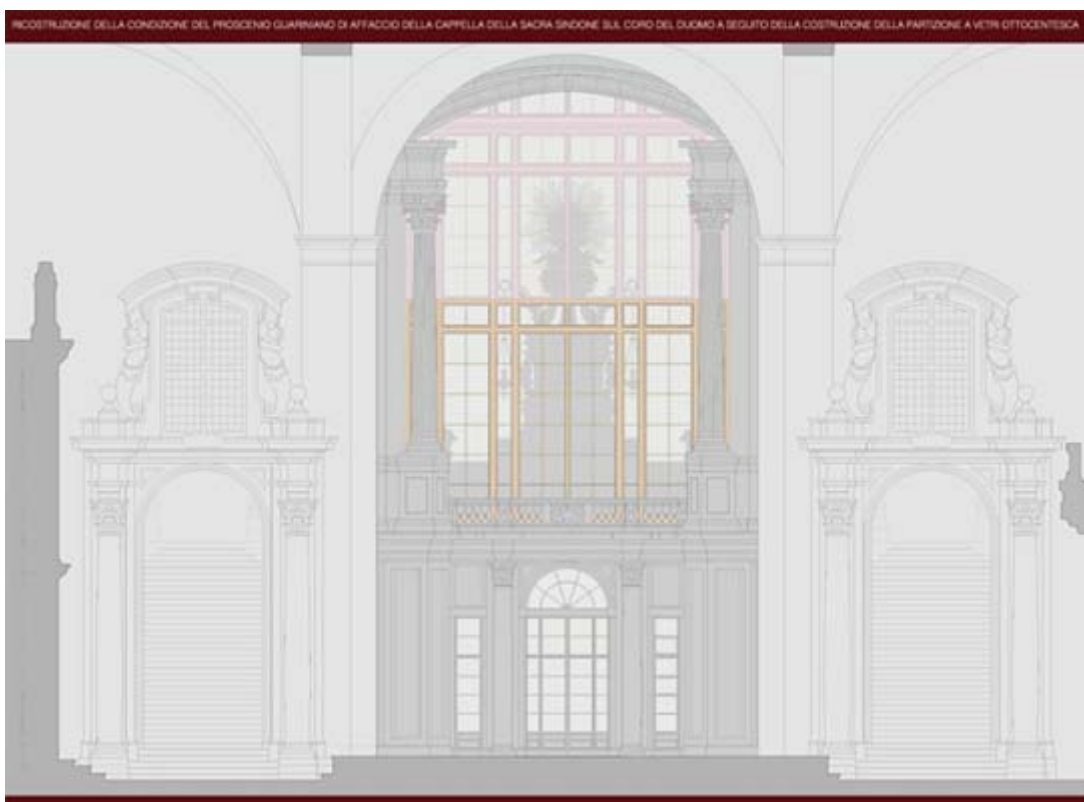
Prospetto fronte Duomo della partizione a vetri ottocentesca. Integrazione tra rilievo (parte inferiore, di colore più chiaro) e ricostruzione. (scala originaria del disegno 1:50)
