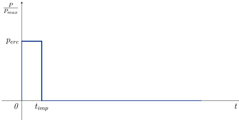
Figura 2.3: Forma dell'impulso termico
