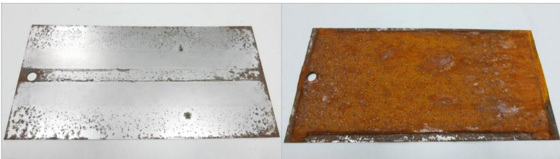
Figura 38-superfici anteriore (sx) e posteriore (dx) del campione corroso per 6 settimane in camera salina
