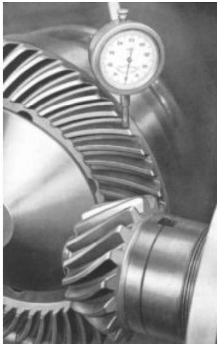
**Figura 2.12:** Misura del gioco di una coppia conica tramite comparatore [9]
