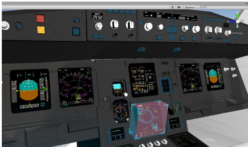
*Figura 66: Esempio di check dell'ECAM System Display*
