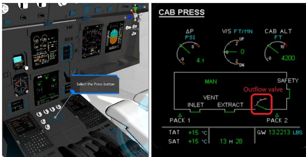
**Figura 69: Tasto per visualizzare sull'ECAM il sistema di pressurizzazione (A sinistra), Display del sistema di pressurizzazione visualizzato (A destra)**
