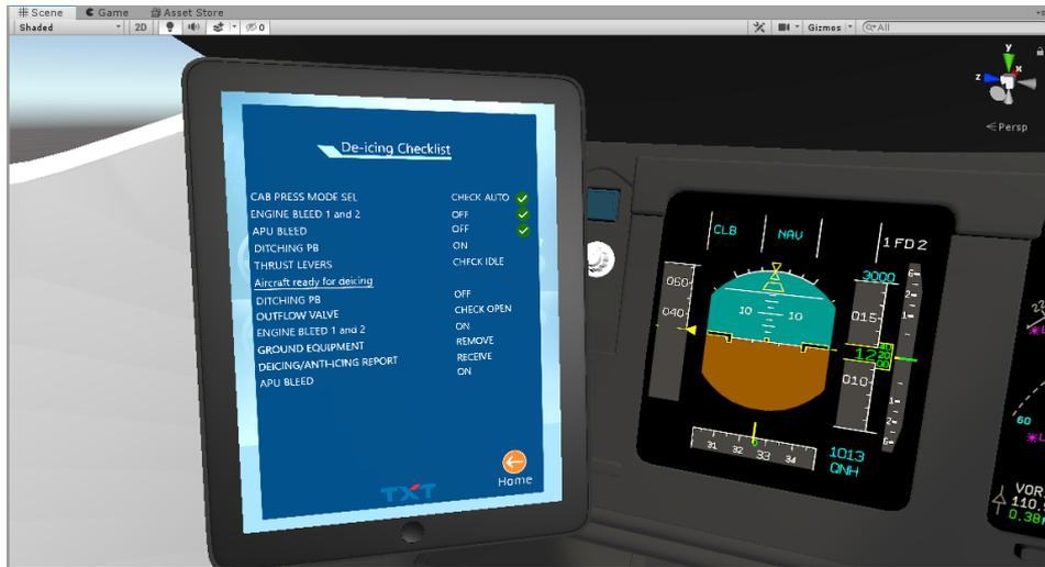
*Figura 65: Esempio checklist della De-icing Procedure durante la sua esecuzione*
