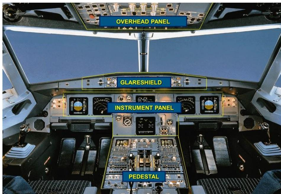
*Figura 47: Distinzione dei pannelli nel cockpit dell'A320<sup>39</sup>*
