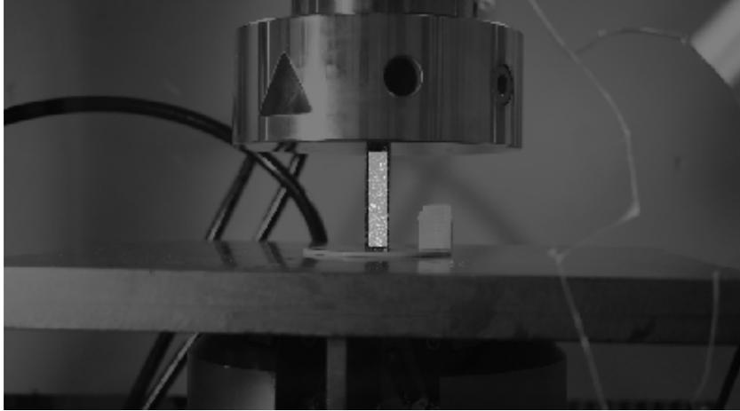
**Figura 3.2:** La definizione della ROI su Ncorr 2D: da notare la distribuzione di grigi sul provino, effettuata tramite vernice spray
