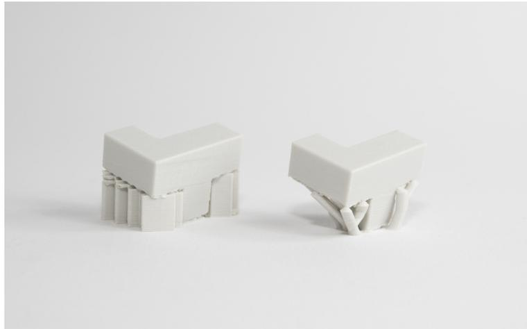
**Figura 1.11:** I due differenti tipi di supporto: a sinistra a reticolo; a destra, ad albero [5]
