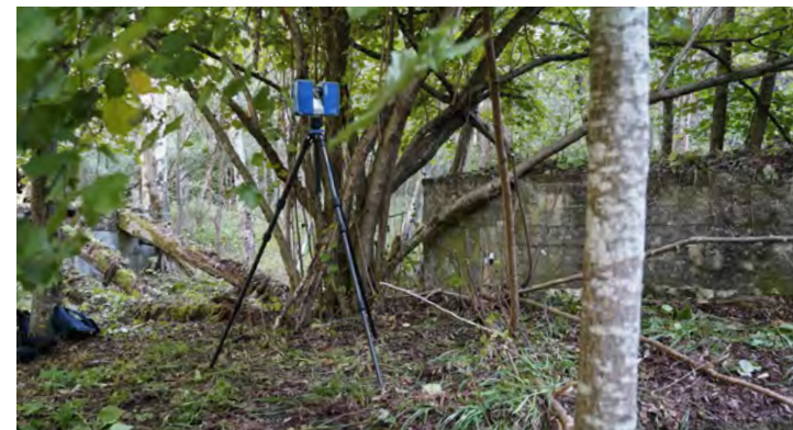
◀ Alcuni momenti delle acquisizioni al sito del ponte, realizzate con laser scanner FARO Focus 3D X330 e S120.
