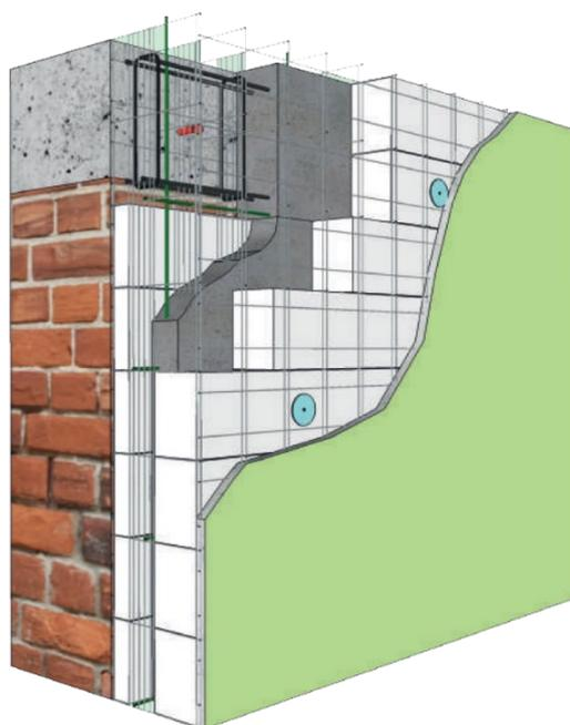
Figura 57: Stratigrafia 3D dei componenti “geniale cappotto sismico”. Materiale fornito da “Ecosism”.2020
