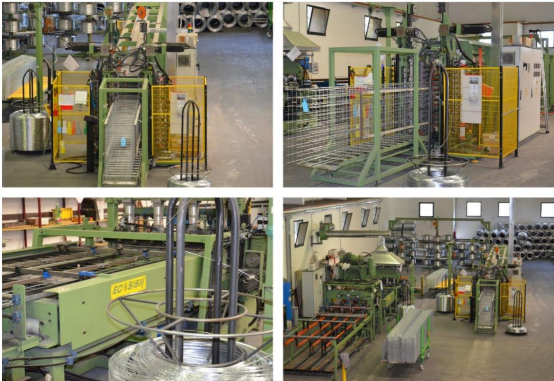
Foto 37: Viste del reparto produttivo Ecosism, dove riusciamo a vedere la macchina di filatura per il blocco 2D e la successiva macchina che assembla i fogli rendendoli tridimensionali (3D machine), Battaglia Terme (PV)
