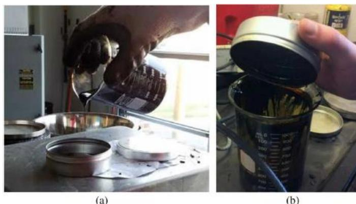
*Figura 4.10 (a) Immersione del legante in lattina sigillabile per l'FSR test; (b) Immersione della miscela BGB per determinare la perdita di legante dovuta alla solubilità nel carburante*
