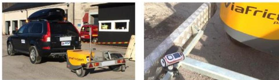
Figura 1.19 Rimorchio e videocamera per effettuare la misurazione con il Friction Test
