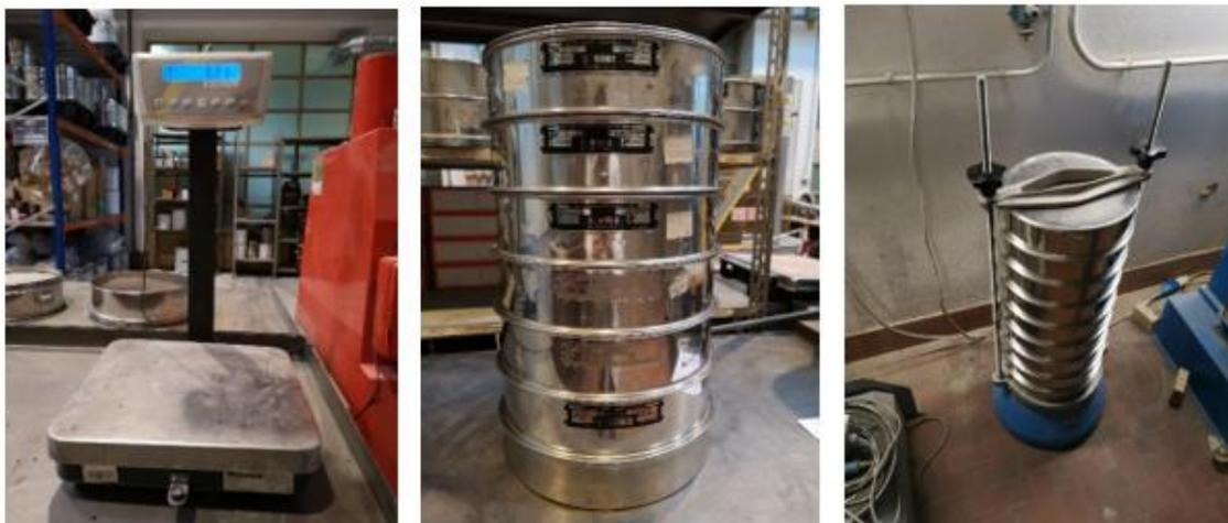
Figura 5.6 Bilancia; pila di setacci; setacciatore meccanico
