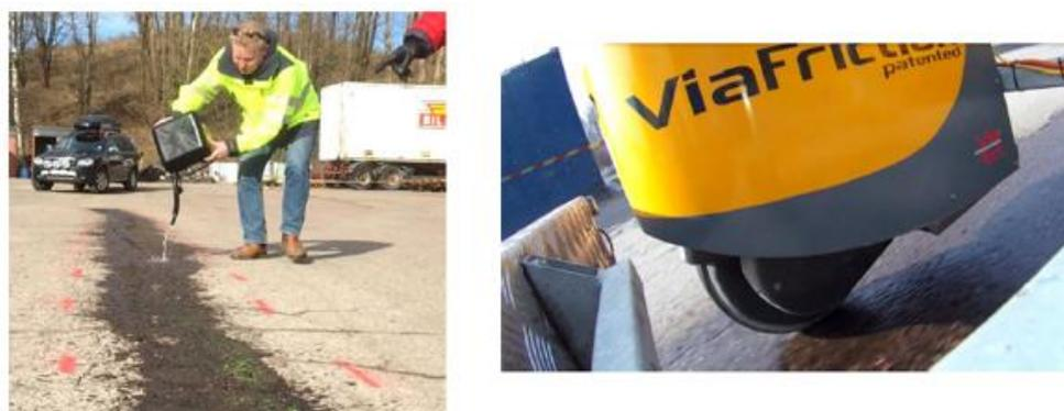
Figura 1.20 Sversamento del carburante e passaggio del rimorchio sulla superficie contaminata
