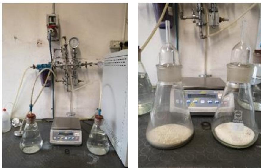
Figura 5.9 Picnometri usati per il calcolo della MMVT
