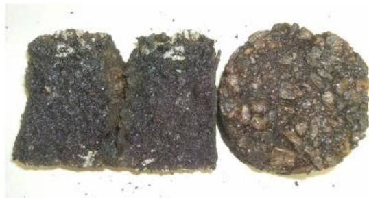
Figura 4.15 Campioni di conglomerato SMA dopo l'immersione nel cherosene
