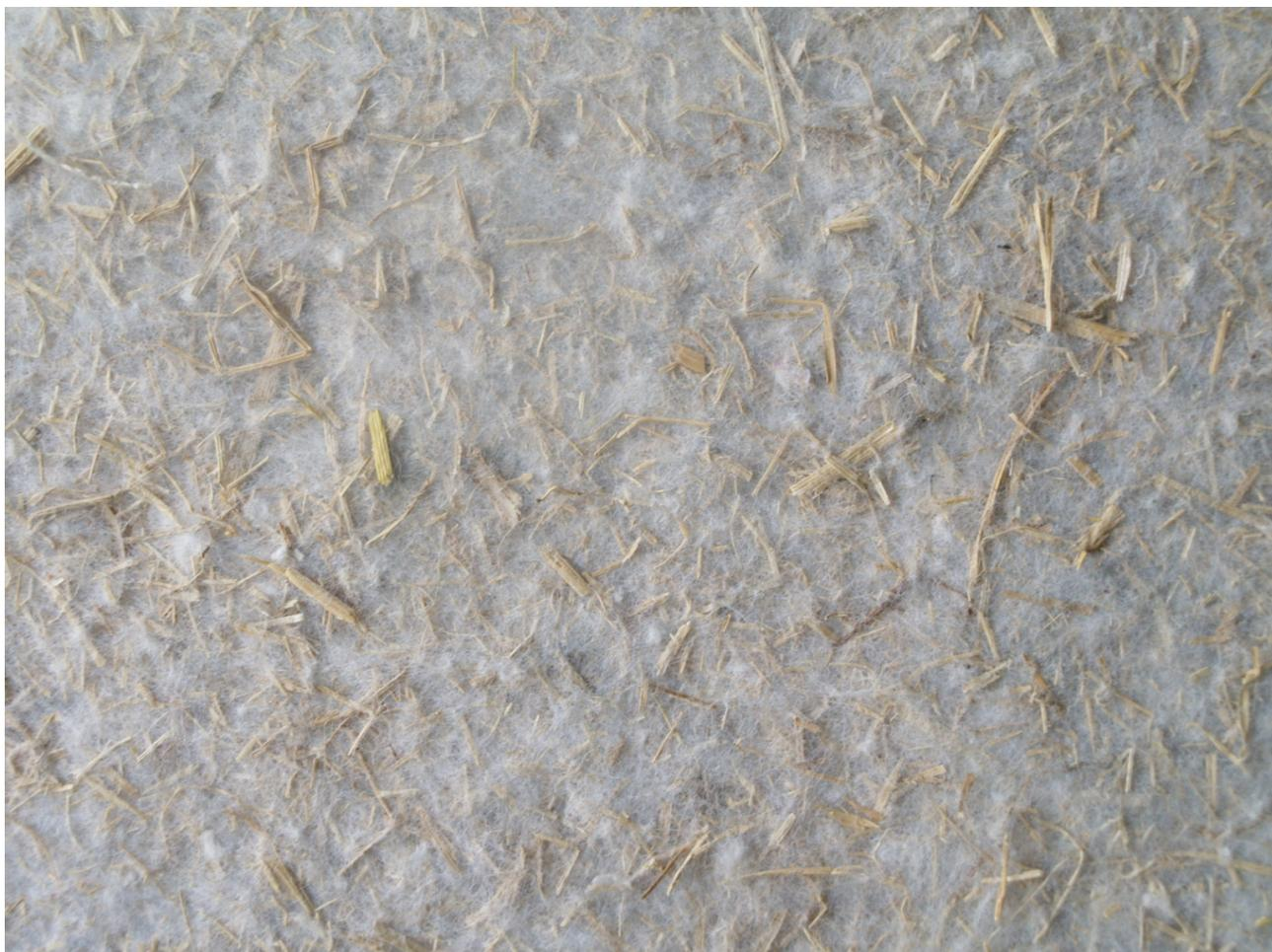
Figura 26: Campione di pannello isolante realizzato con paglia trinciata e granuli di polipropilene da riciclo
