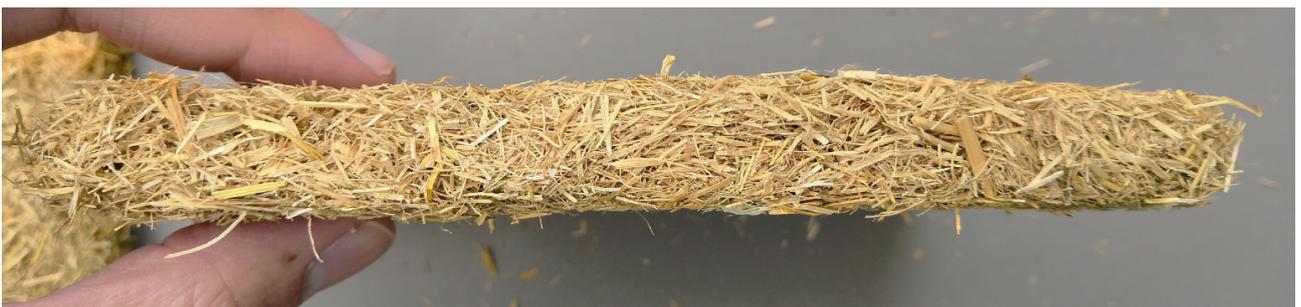
Figura 31: Dettaglio dello spessore del campione contenente una maggiore quantità di paglia trinciata.
