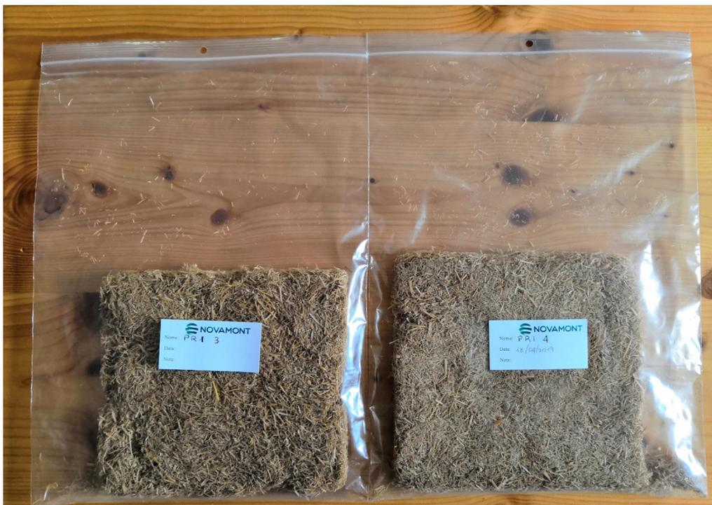
Figura 28: Campioni realizzati da Novamont S.p.A. A sinistra il campione contenente una maggiore quantità di biopolimero. A destra il campione contenente una maggiore quantità di paglia trinciata.
