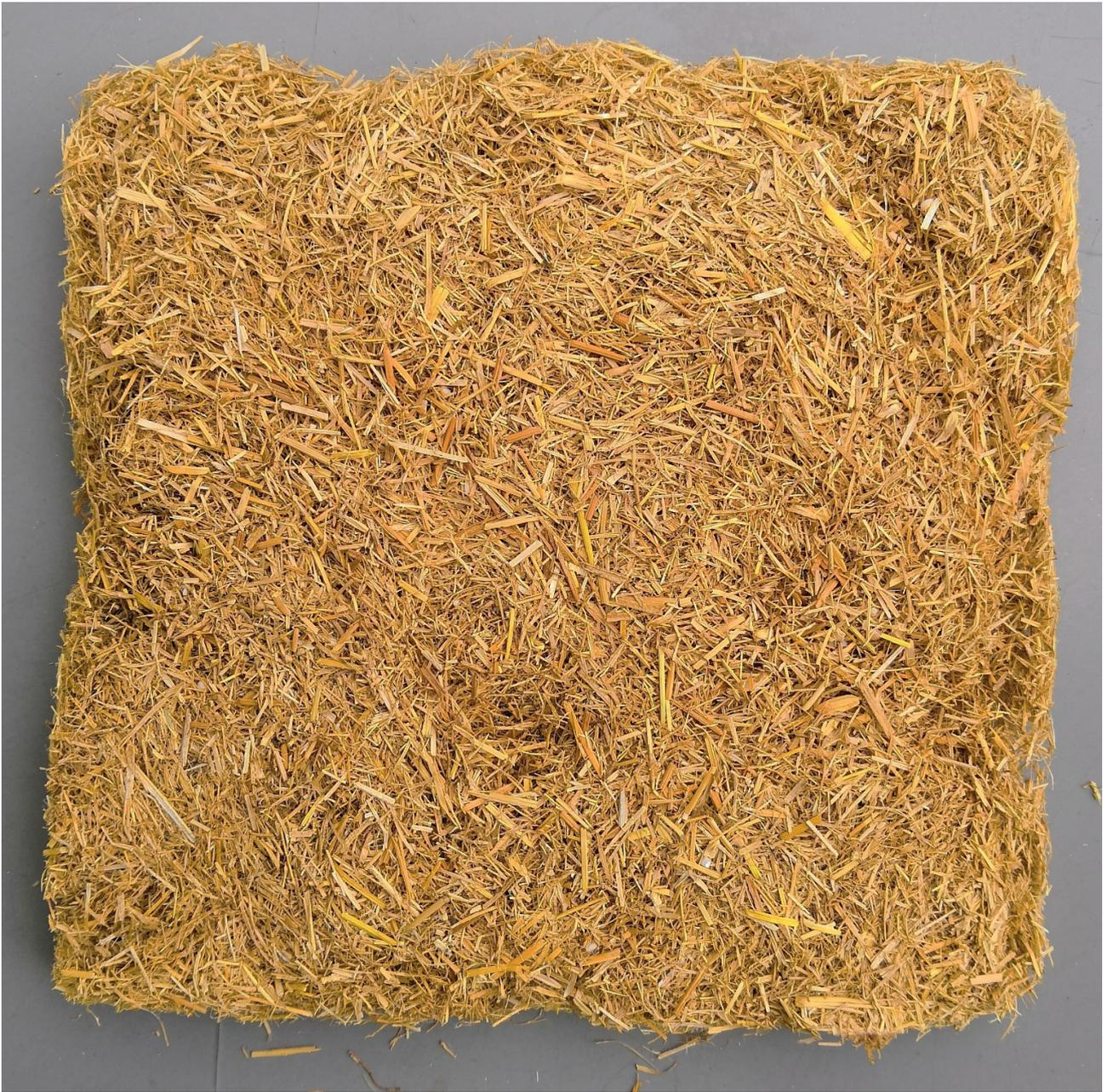
Figura 29: Dettaglio del campione contenente una maggiore quantità di biopolimero.
