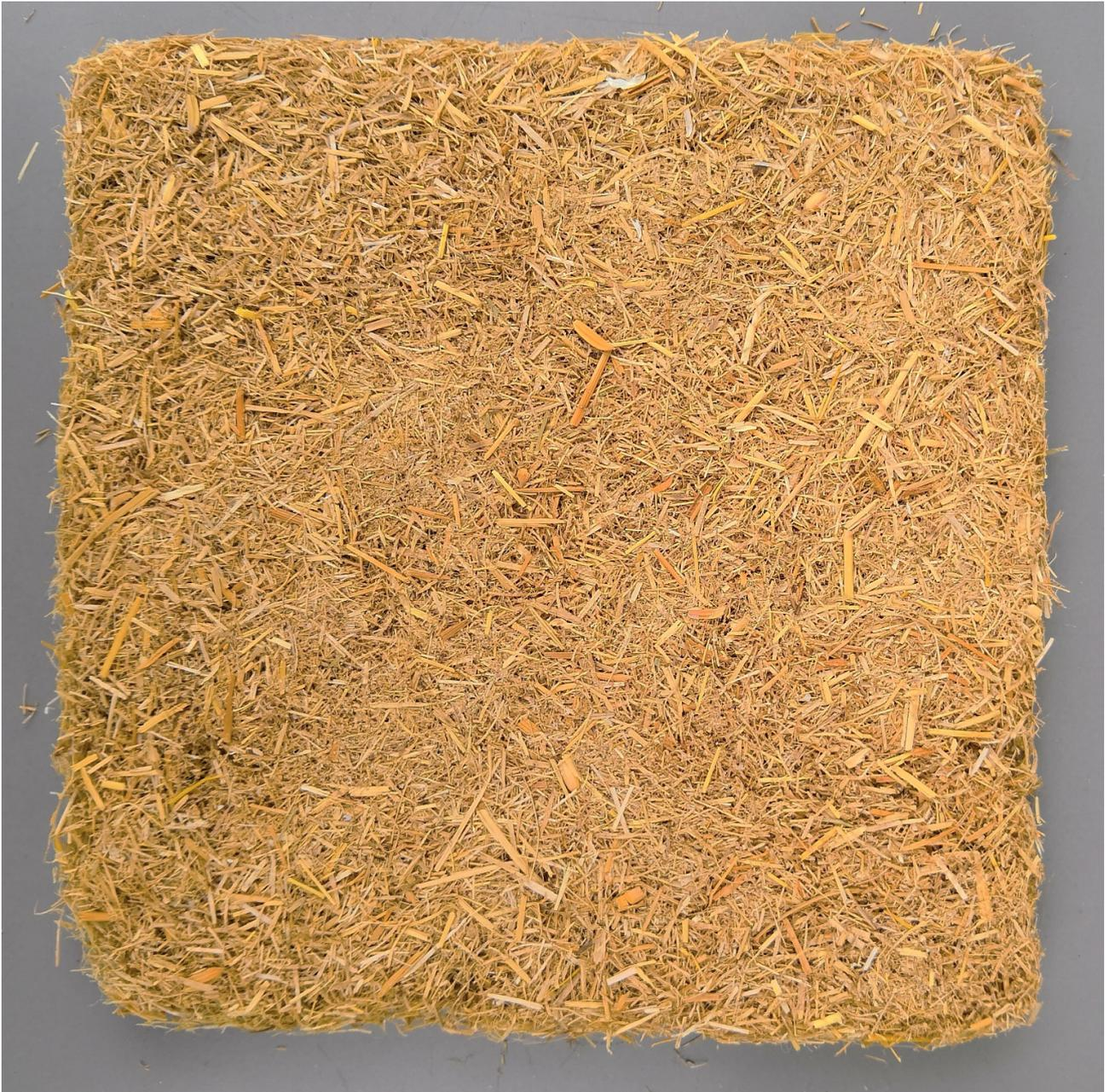
Figura 30: Dettaglio del campione contenente una maggiore quantità di paglia trinciata.
