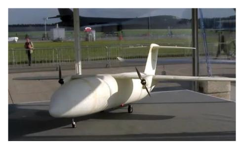
Fig. 17. "Thor". First 3D printed mini airplane
