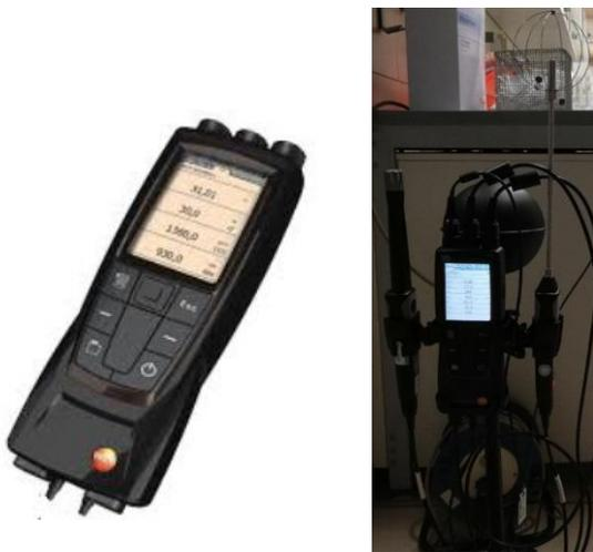
Figura 2.2.1.1 Testo 480 e sonde collegate
