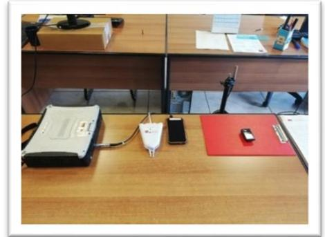
Figura 2.1.9 Foto del SoundBook, Air Beam, Testo 480, SEM, testo 174H
