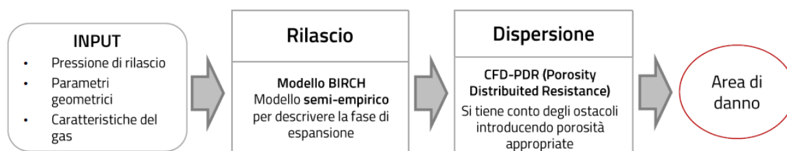
Figura 1.4– Schema dell'approccio utilizzato da FLACS e KFX
