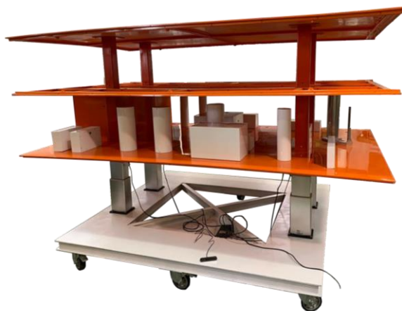
Figura 2.8 – Mock-Up: modello in scala 1:10 della piattaforma reale
