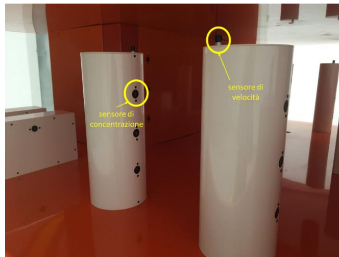
Figura 5.6 – Sensori di concentrazione e di velocità installati sugli ostacoli
