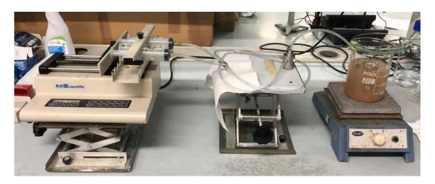
Figura 2.2: Strumentazione per la sintesi del catalizzatore mediante reattore VORTEX
