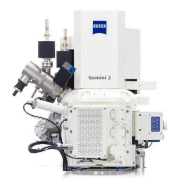
**Figura 2.9:** Microscopio elettronico a scansione con sorgente ad emissione di campo (Zeiss Merlin Gemini II Column)(MedicalExpo, 2020)
