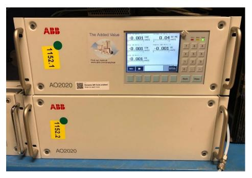
Figura 2.13: Analizzatore NDIR ABB
