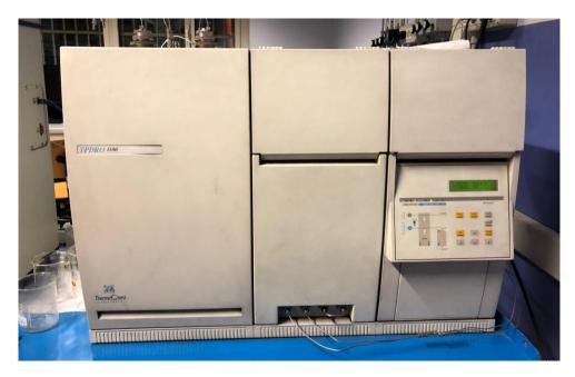
Figura 2.6: Analizzatore TPD/R/O 1100 (Catalytic Surface Analizer) della ditta TermoQuest
