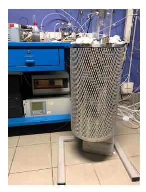
Figura 2.11: Forno dotato di scambiatore di calore a struttura cilindrica per effettuare il test catalitico
