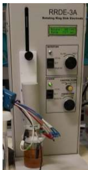
Figura 7.1: Cella elettrochimica utilizzata per gli esperimenti.
