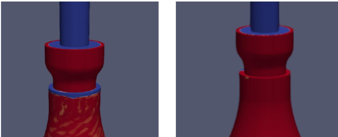
**Figura 5.14:** Sinistra: anello di gas intrappolato ad ingresso bottiglia nei primi istanti di simulazione.
