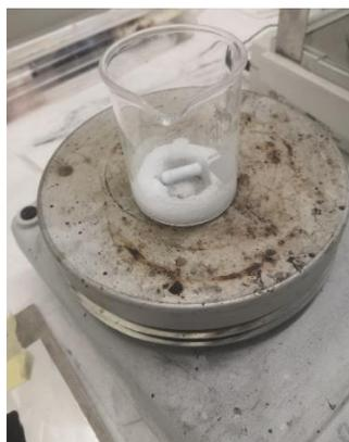
Figura 5-1: piastra e agitatore magnetico utilizzati per la cristallizzazione dei materiali
