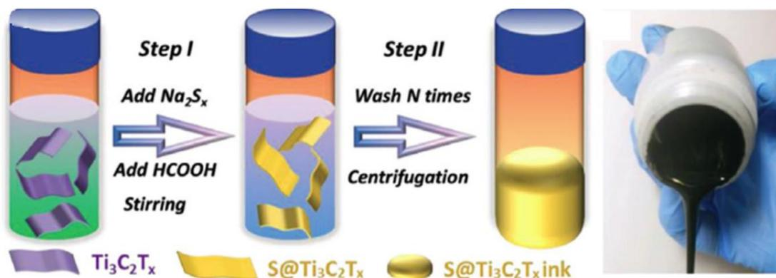
Figura 3-37: processo di sintesi di uno slurry binder free a base di  $Ti_3C_2T_x$  e zolfo, applicabile direttamente nei processi di slurry-casting o filtrazione [29]
