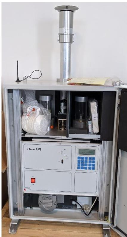
*Figura 6.2: Sequenzial Particulate sampler LVS16 MCZ Umwelttechnik*
