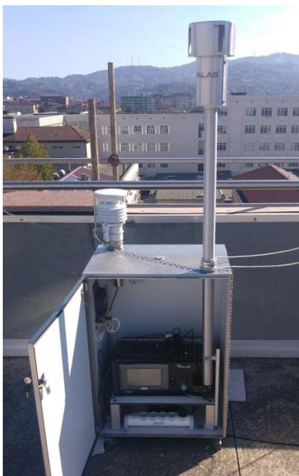
*Figura 6.17: Analizzatore Palas Fidas 200S posto sul sito di misurazione presso il Green Roof Lab*
