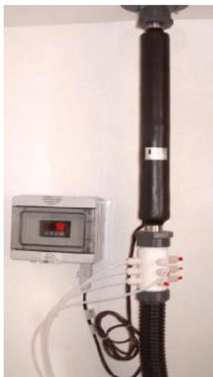
*Figura 6.4: Sonda di campionamento, dettaglio sul manifold e sul preriscaldatore del flusso d'aria [SARTEC]*
