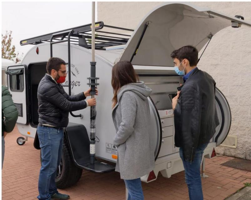
*Figura 6.5: Attività di prova del posizionamento della sonda di campionamento sul passaruota sinistro del carrello.*
