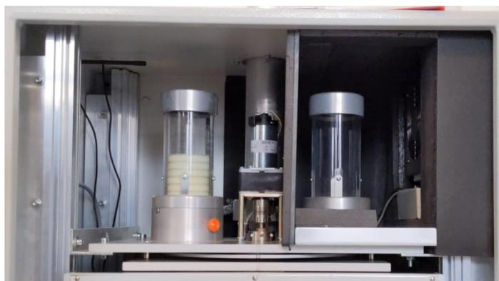
*Figura 6.3: Dettaglio dell'LVS16. Sulla destra è posizionata la camera di stoccaggio dei filtri usati; sulla sinistra sono posti nel portafiltri i filtri vergini che verranno prelevati per il campionamento*
