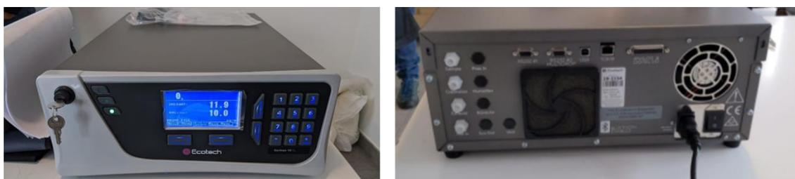
Figura 6.8: Vista frontale e vista posteriore del Serinus10 ozone analyser
