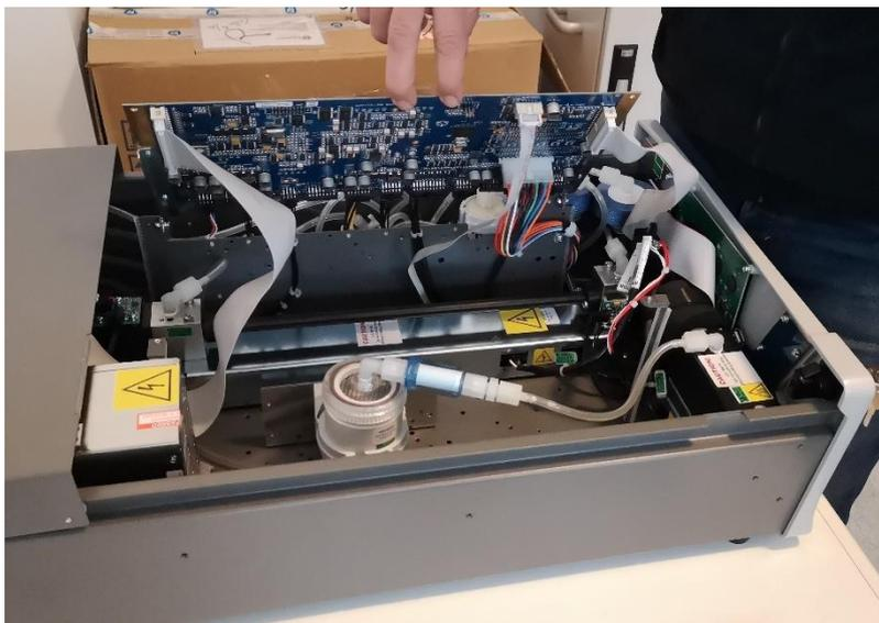
Figura 6.7: Vista dall'alto della struttura interna del Serinus10 ozone analyser.
