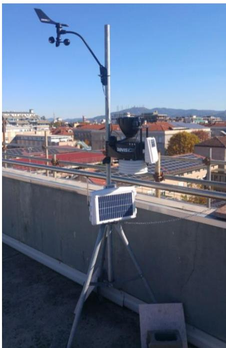
*Figura 6.14: Stazione meteo Davis Vantage Pro 2 posta sul sito di misurazione presso il Green Roof Lab*
