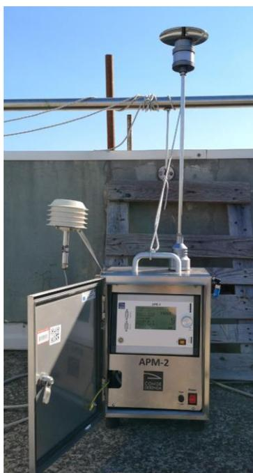
*Figura 6.15: Analizzatore Comde Derenda APM2 2 posto sul sito di misurazione presso il Green Roof Lab*
