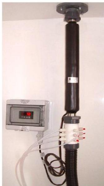
*Figura 4.15. Sonda gas Sartec (fonte: Sartec - Saras Ricerche e Tecnologie Srl, Sonda campionamento inquinanti gassosi)*
