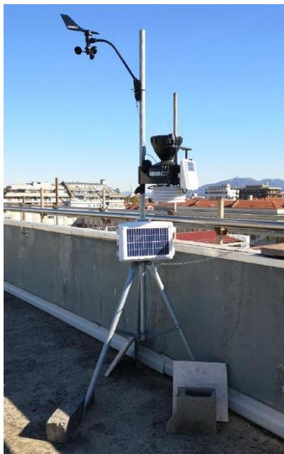
*Figura 4.16. Stazione meteo Vantage Pro2 Davis Instruments.*
