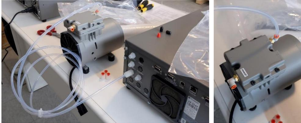
*Figura 4.10. Dettaglio collegamento pompa esterna.*
