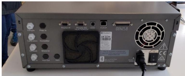
Figura 4.13. Retro dell'analizzatore Serinus 10 Ecotech.
