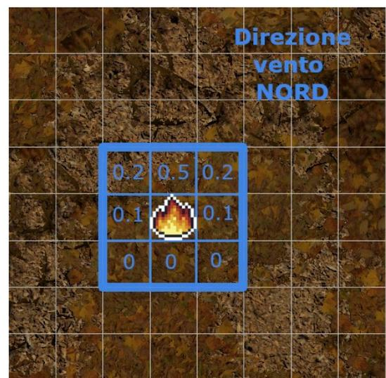
Figura 33 Visualizzazione della matrice del vento
