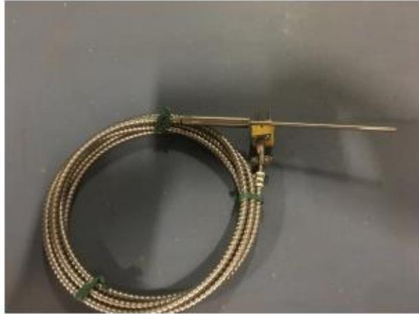
**Figura 4.14** *Termocoppia di tipo K*
