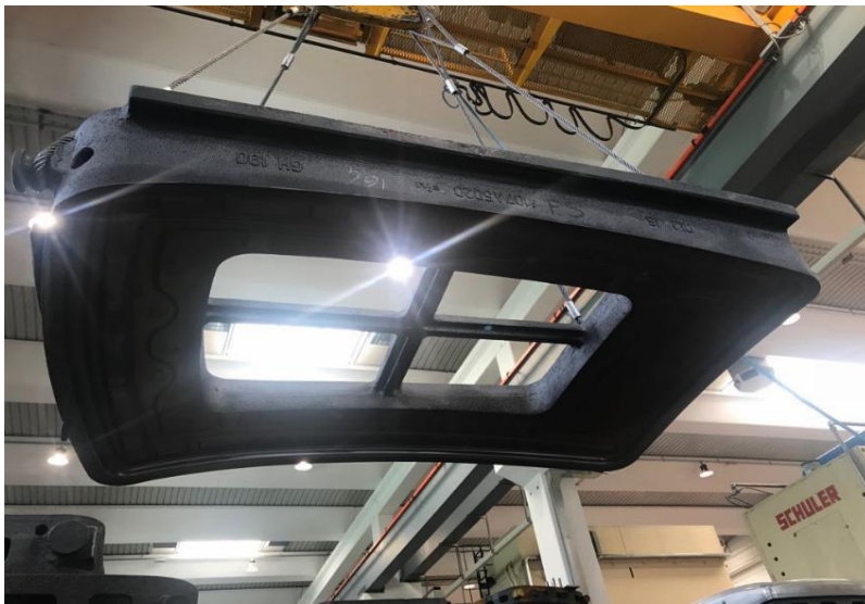
Figura 17 Esempio di stampo in ghisa, sollevato dal carroponte
