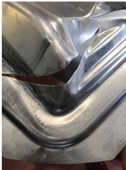
Figura 19 esempio di rottura per scarso scorrimento del foglio di lamiera durante il processo di formatura sotto pressa.
