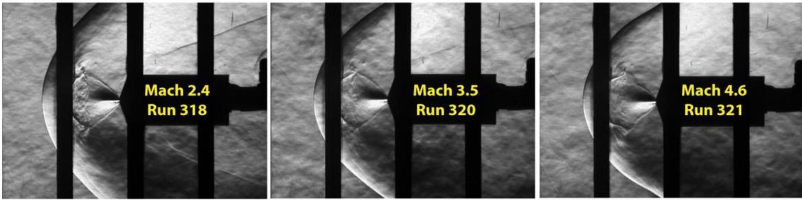
Figura 6-3 Schlieren configurazione single nozzle (20)
