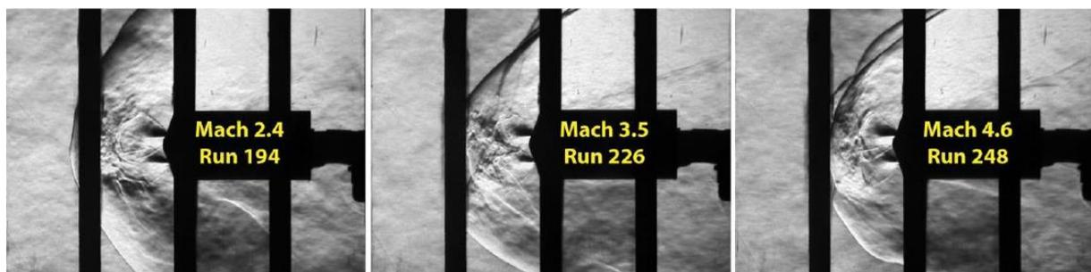
Figura 7-1 Schlieren configurazione tri-nozzle (20)
