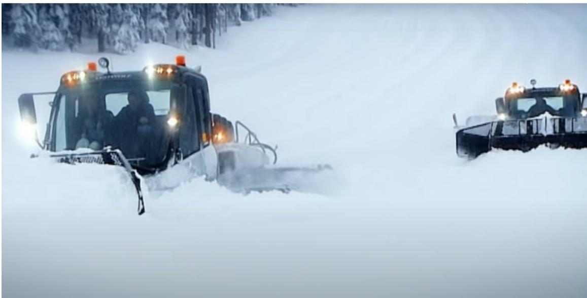
Figura 27: Prima fase della battitura delle piste in cui la lama distribuisce uniformemente la neve
