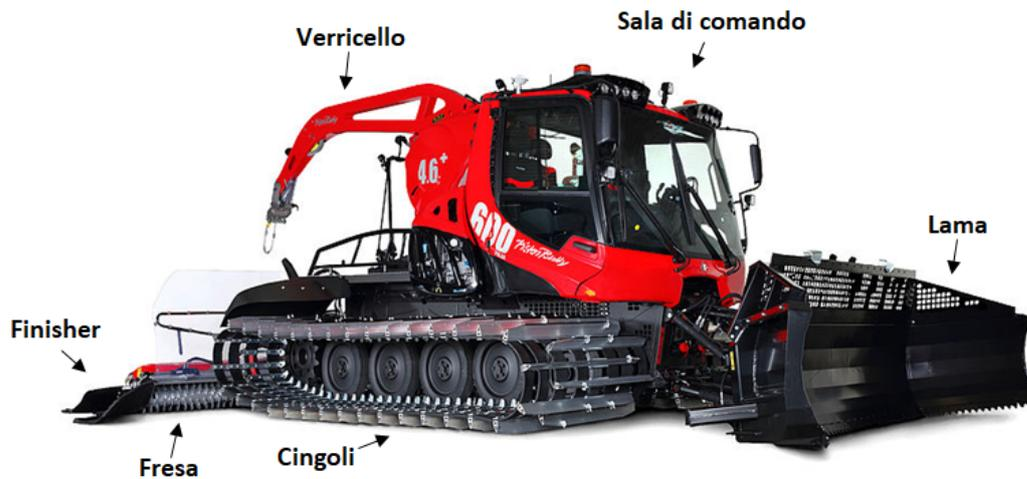
Figura 26: Componenti che costituiscono un mezzo batti-pista
