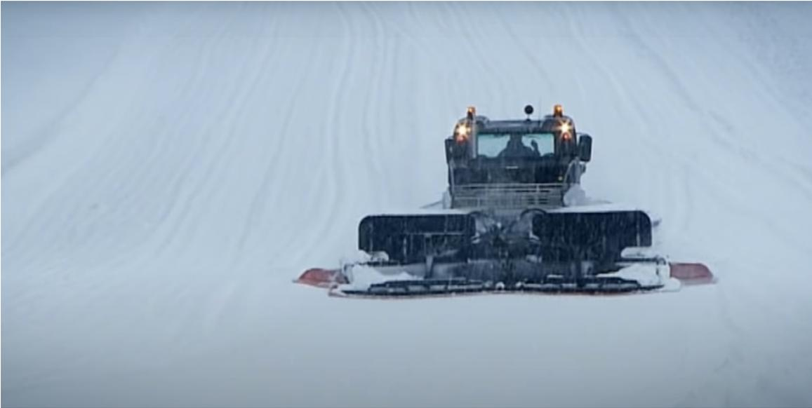
*Figura 28: Seconda fase in cui sono i cingoli a compattare la neve appena smossa dalla lama*
