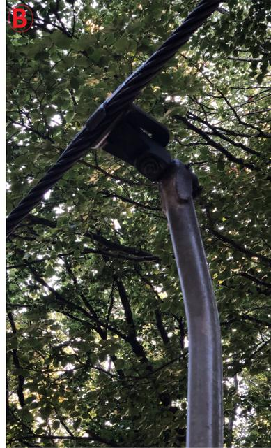
Figura 4: Nella foto di sinistra si può vedere un sistema ad ammorsamento automatico in cui il disco rosso, una volta raggiunta la stazione, svincola il veicolo dalla fune principale e lo deposita attraverso le due ruote bianche su un'apposita guida. Sulla destra invece si raffigura un sistema ad ammorsamento fisso in cui la seggiovia rimane sempre ancorata alla fune anche in prossimità della stazione di arrivo o partenza.
