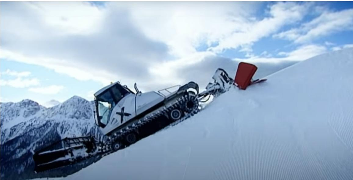
*Figura 29: Penultima fase in cui la fresa entra in funzione per frantumare ulteriormente la neve più compatta*
