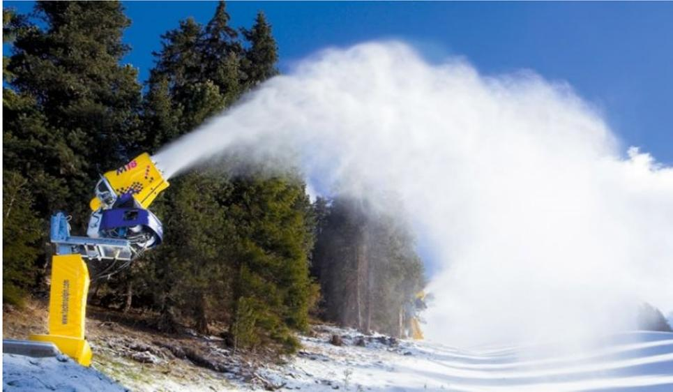
*Figura 21: Esempio di cannone a bassa pressione.*
