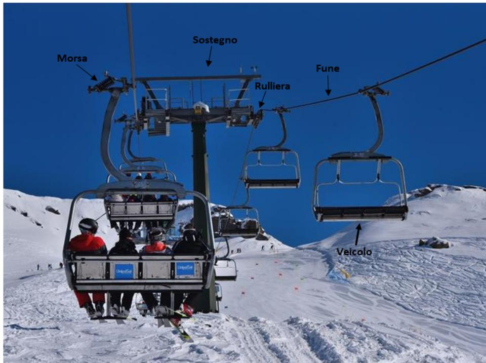
Figura 3: Immagine riassuntiva della componentistica che costituisce un impianto di risalita.
