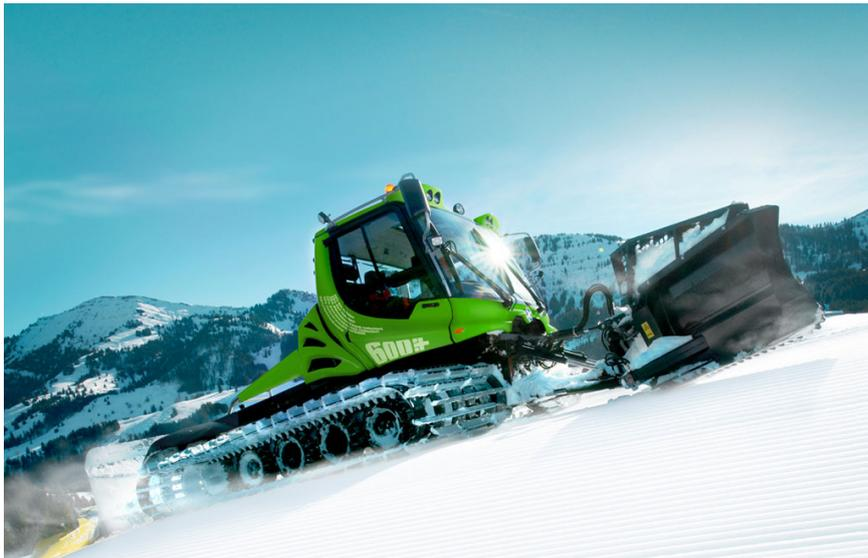
*Figura 47: Pistenbully-600 E+, uno tra i primi e più efficienti battipista ibridi realizzati ad oggi*
