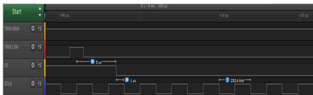
Figura 8.16: Verifica ritardo tra inizio ISR/CS e tra fronte di discesa del CS e fronte di discesa di SCLK, test 2
