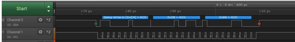
Figura 6.6: Andamenti di SDA e SCL della comunicazione I2C
