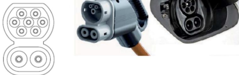
Figura 2.5: Tipi di connettori modo 4, standard CCS COMBO2
