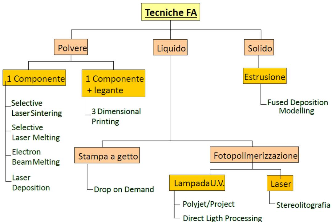
Figura 2 : Classificazione tecniche di fabbricazione additiva [4]
