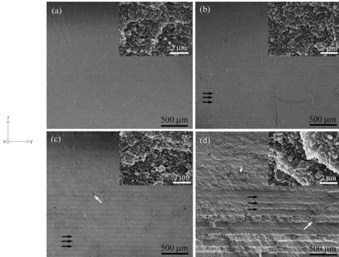
Figura 11 : Micrografie di campioni verdi con diversi spessori di strato: a) 30  $\mu\text{m}$ ; b) 60  $\mu\text{m}$ ; c) 90  $\mu\text{m}$ ; d) 120  $\mu\text{m}$ . [16]
