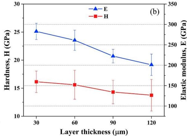
Figura 12 : Variazione di durezza e di modulo di Young per i quattro campioni (Hardness = durezza; Layer thickness = Spessore di strato; Elastic modulus = Modulo di Young) [16]
