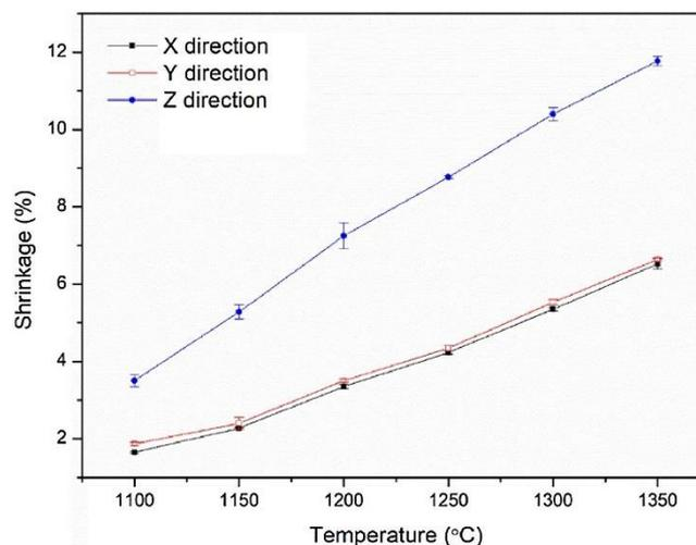
Figura 16: Ritiro in campioni sinterizzati a diverse temperature sotto vuoto [15]
