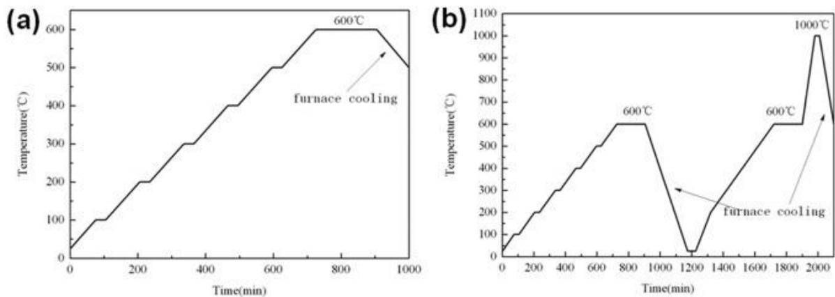
Figura 14 : (a) Deceratura per pirolisi ad aria e deceratura sottovuoto e (b) Deceratura in due fasi. [18]
