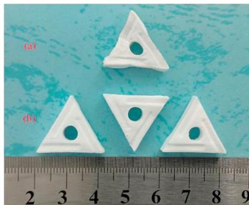
Figura 13 : (a) Campione verde essiccato attraverso un processo di essiccazione naturale e (b) campioni verdi essiccati tramite un processo di essiccazione assistita da un liquido essiccante (PEG) [18]
