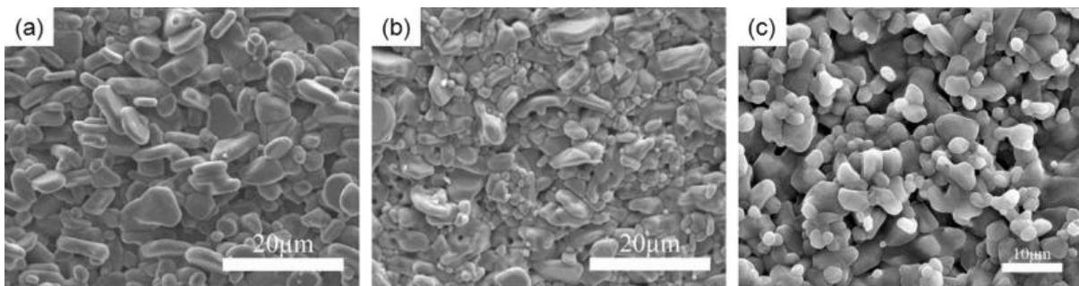
*Figura 6 : Immagini al SEM che rivelano la morfologia dei campioni sottoposti al processo di deceratura termica: a) campione 1, b) campione 2, c) campione 3. [13]*
