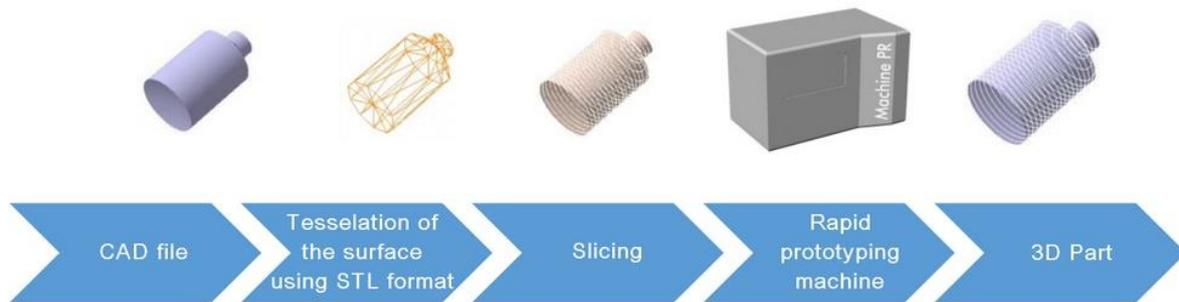
Figura 1 : Processo per la fabbricazione additiva
