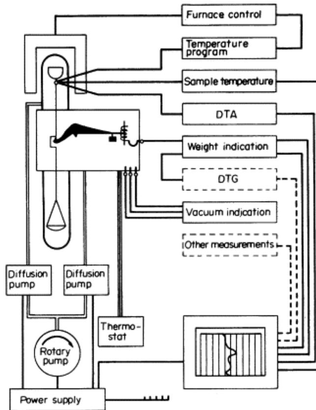
Figure 10.9 : TGA apparatus [63]
