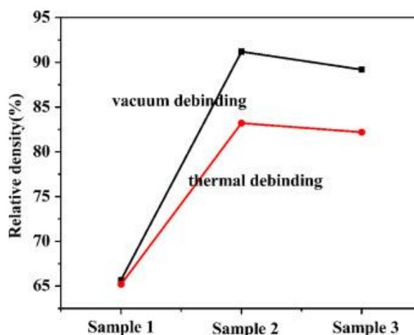
*Figura 7 : Confronto delle densità relative dei diversi campioni dopo deceratura. Sia deceratura sottovuoto (vacuum debinding) che deceratura termica (thermal debinding) [13]*
