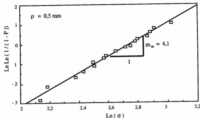
Figure 1.4 : Estimation of WEIBULL parameters [28]
