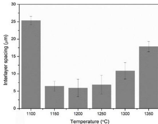
Figura 15: Evoluzione della spaziatura tra gli strati a diverse temperature di sinterizzazione [15]
