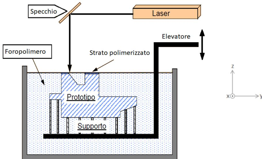
Figura 3 : Stereolitografia [4]
