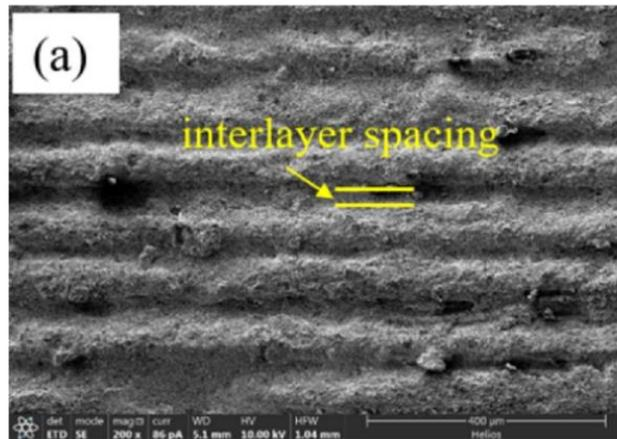
Figura 10 : Esempio di un'immagine al SEM che mostra la delaminazione dopo sinterizzazione (qui a 1100°C) di una superficie lucidata[15]
