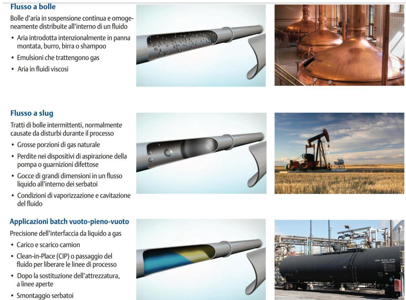
**Figura 7.17:** Descrizione e raffigurazione delle tipologie di flusso bifasico. Figura tratta da [10].
