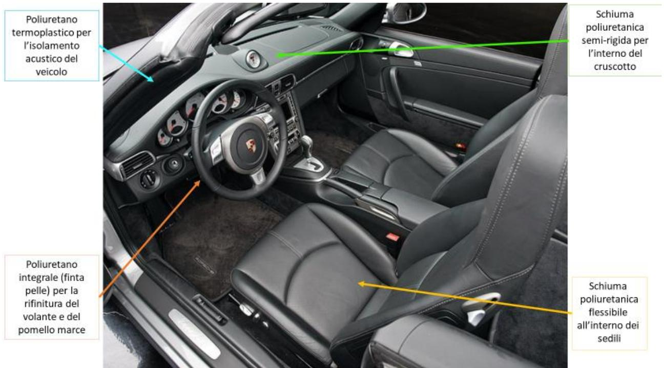
**Figura 3.6:** esempio visivo delle possibili applicazioni del poliuretano per gli interni e l'isolamento acustico di un'automobile. Figura tratta da [16] con modifiche.
