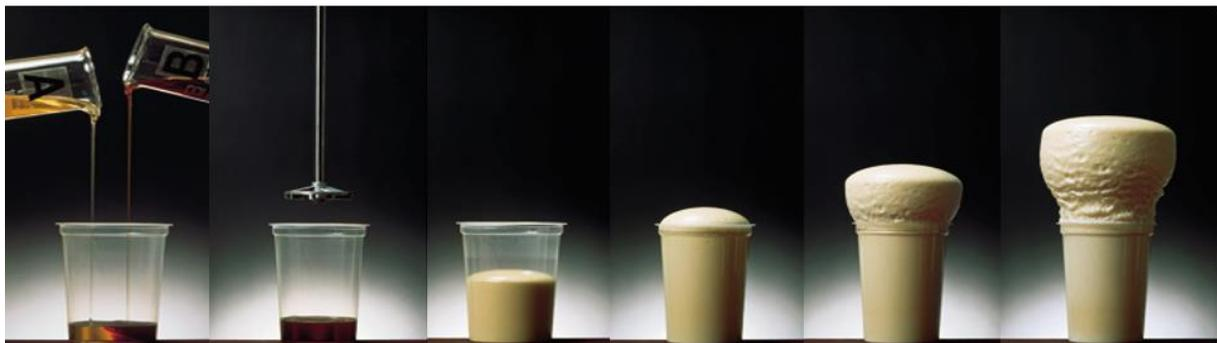
**Figura 3.1:** Sequenza di reazione fra isocianato e poliolo con produzione di schiuma poliuretanicca. Figura tratta da [13].
