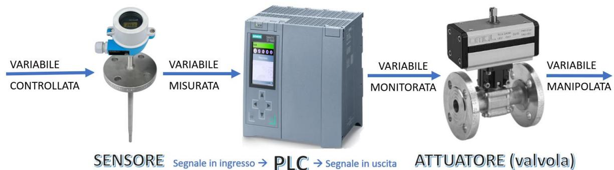
**Figura 5.1:** Diagramma di flusso di una logica di controllo o sicurezza implementata nel sistema di automazione tramite PLC.
