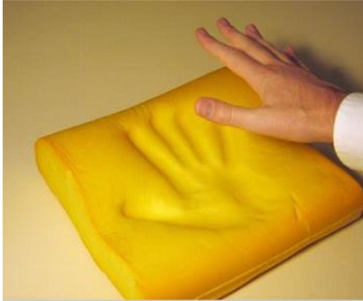
**Figura 3.5:** Memory foam con un ritorno elastico lento rispetto alla schiuma elastica. Si noti il caratteristico ingiallimento del poliuretano causato dall'esposizione alla luce. Figura tratta da [15]
