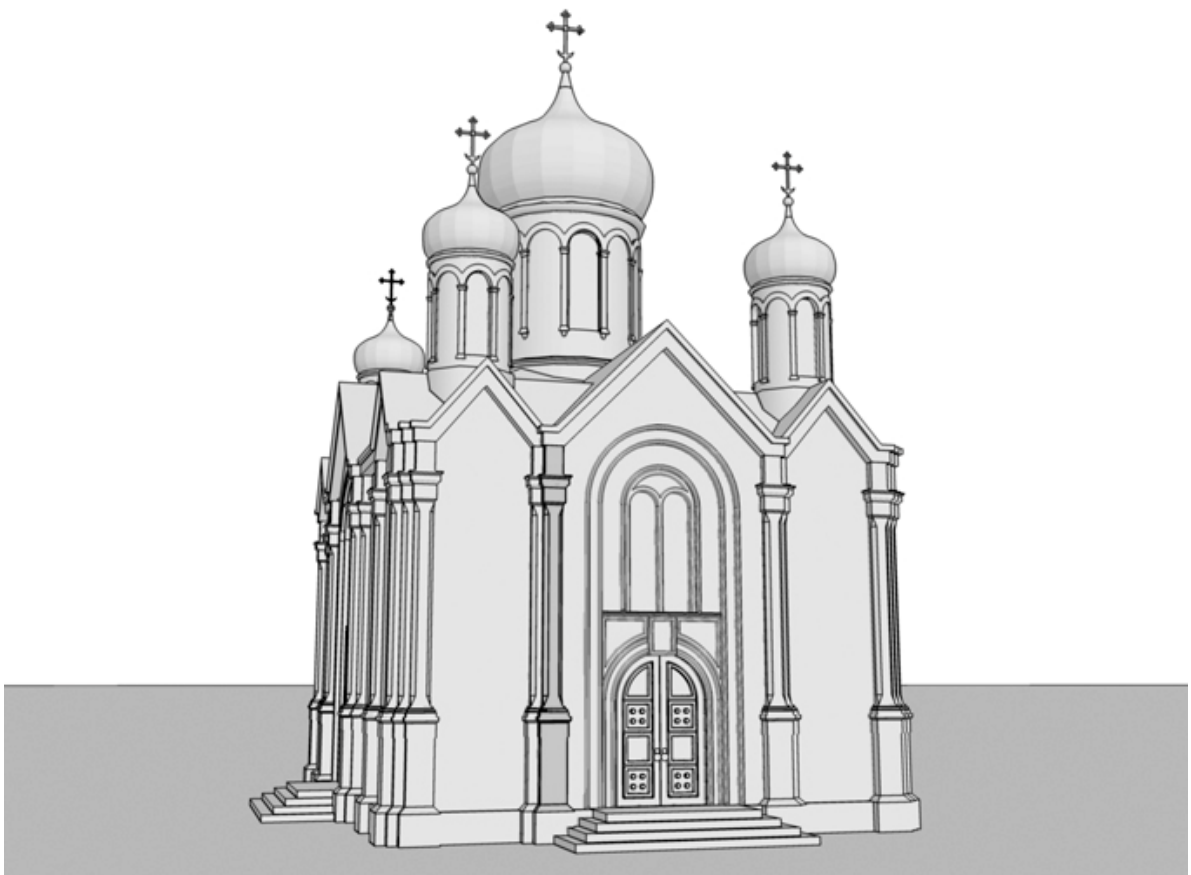
Figura 1a.4 (Parte I) - Modello semplificato di una tipica chiesa barocca moscovita. Gli elementi caratterizzanti sono le cupole con i tamburi ornati ad arcate, l'ingresso principale con la nicchia per la statua del santo e lo zoccolo di fondazione su cui si appoggia l'intera struttura. In: http://files.school-collection.edu.ru/
