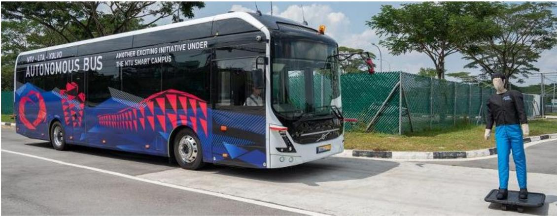
Figura 56: Volvo Enviro200, il primo autobus elettrico autonomo da 12 metri con una capacità piena vicino a 80 passeggeri.
