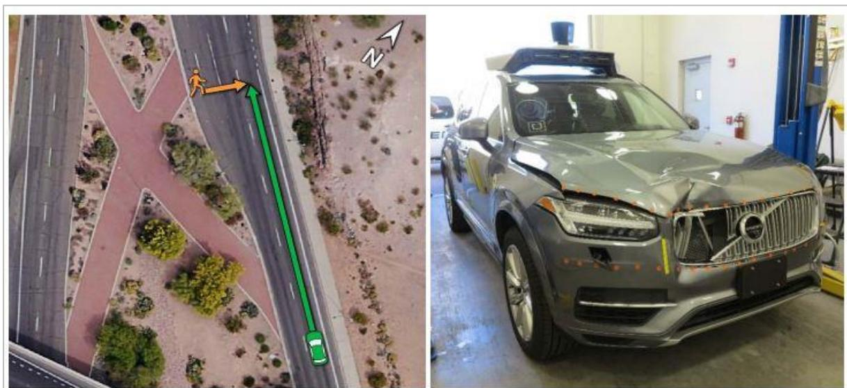
Figura 49: (A sinistra) Posizione dell'incidente sulla Mill Avenue in direzione nord, che mostra i percorsi del pedone in arancione e del veicolo di prova Uber in verde. (A destra) Vista post-scontro del veicolo di prova Uber, che mostra danni al lato anteriore destro. Fonte: [https://www.nts.gov/investigations/AccidentReports/ Reports/HWY18MH010-prelim.pdf](https://www.nts.gov/investigations/AccidentReports/Reports/HWY18MH010-prelim.pdf).
