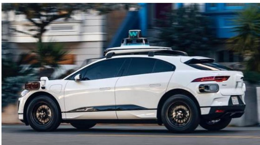
Figura 22: Auto a guida autonoma di quinta generazione dell'azienda Waymo. Sono ben riconoscibili i numerosi sensori posti nei lati e sul tetto del veicolo.
