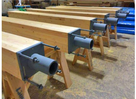
Fase di cantierizzazione della struttura ibrida dell'edificio ed elementi verticali prefabbricati in Glulam nello stabilimento di produzione, già provvisti di connettori di ancoraggio ai piani orizzontali e pronti all'installazione in cantiere tramite montaggio a secco
