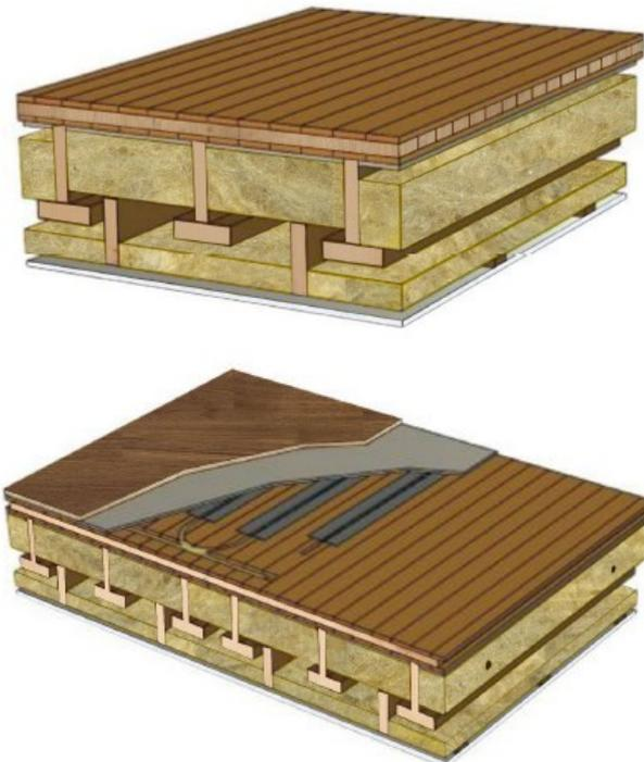
*Stratigrafie degli elementi di solaio di partizione orizzontale della struttura dell'edificio e sistema di riscaldamento a pavimento – elaborazione degli autori*
