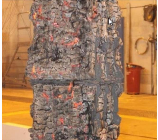
*Connessione metallica ad alta capacità in acciaio scanalato che assicura una sicurezza strutturale in caso di incendio*
