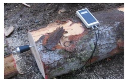
*Schema del funzionamento di un sistema a propagazione di onde e strumentazione in funzione su un tronco appena tagliato*
