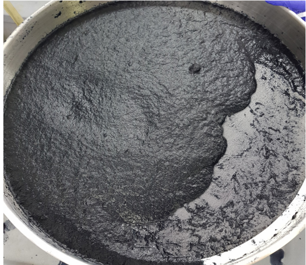
Figura 34 - Scolatura della miscela tramite setaccio
