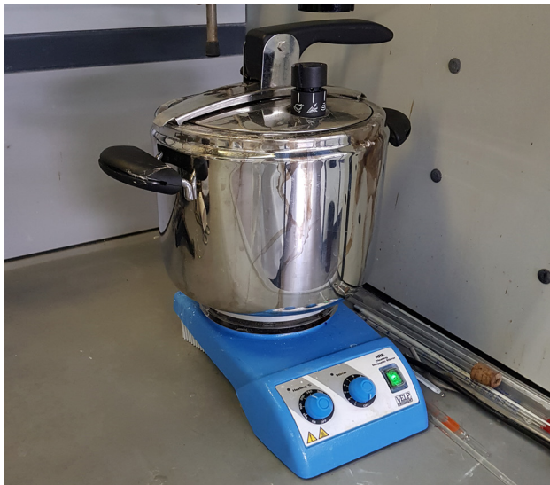
Figura 31 - Riscaldamento della soda caustica (NaCl)
