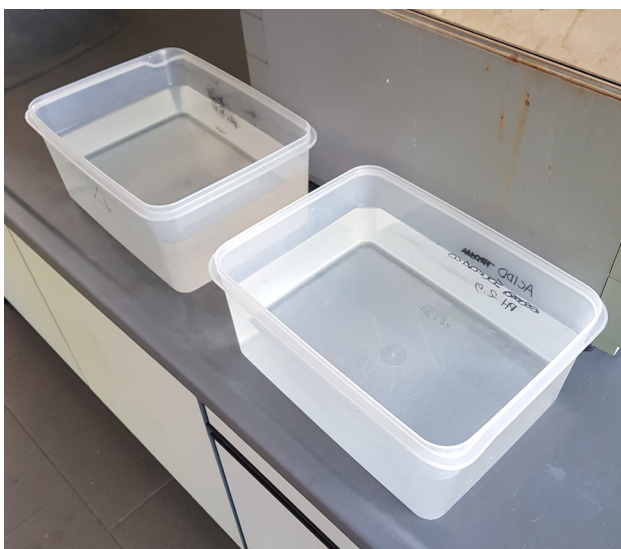
Figura 33 - Preparazione dei bagni acidi di lavaggio
