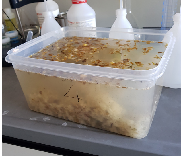
Figura 17 - Poltiglia di lana e trinciato di mais immersa in acido
