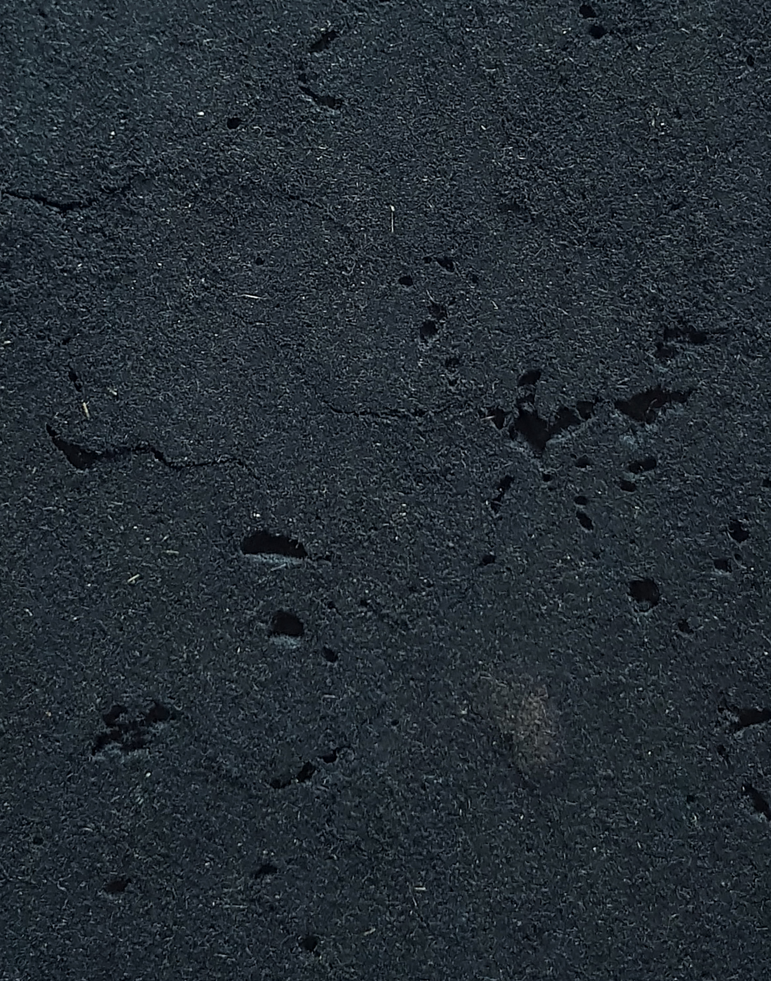
Figura 3 - Pannello AGROTESs C (polveri tessili laniere)
