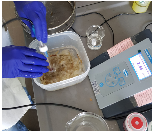
Figura 18 - Controllo del pH della soluzione con pHmetro
