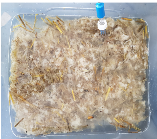
Figura 16 - Poltiglia lana e paglia immersa in acido
