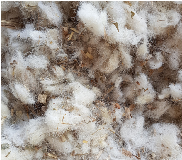
Figura 8 - Miscela di lana autoctona e trinciato di mais
