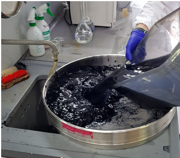
Figura 37 - Scolatura della miscela tra i passaggi in acido
