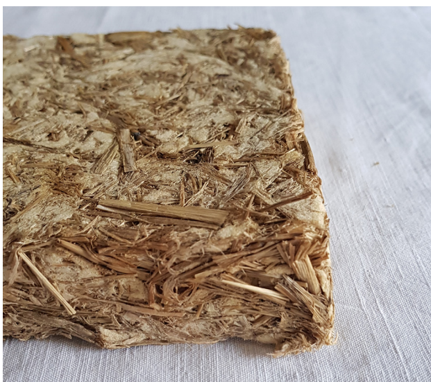
Figura 22 - Pannello AGROTESs A (dettaglio)
