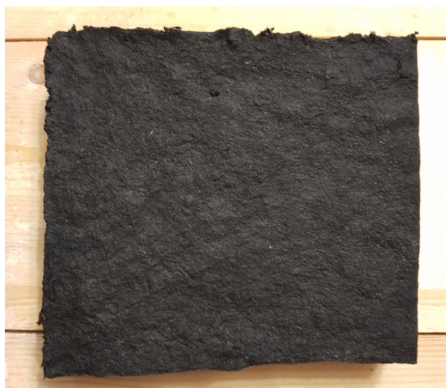
Figura 46 - Pannello AGROTESs C1 tagliato e testato
