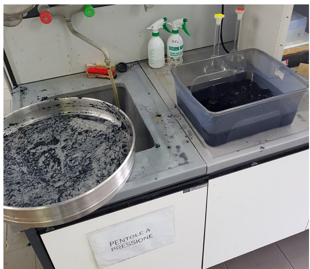
Figura 36 - Poltiglia di polveri tessili immersa in acido
