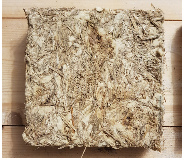
Figura 44 - Pannello AGROTESs A tagliato e testato
