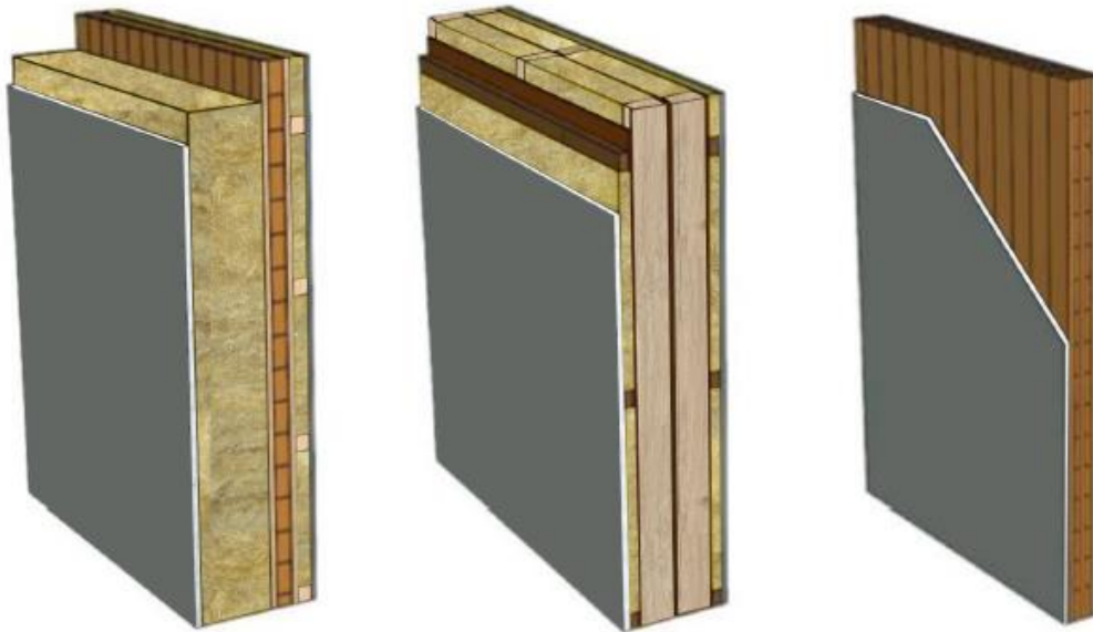
Stratigrafie delle chiusure verticali opache verso l'esterno, delle pareti di separazione tra le unità abitative dell'edificio e delle partizioni interne a ciascun appartamento – elaborazione degli autori
