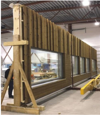
Elementi prefabbricati della facciata nello stabilimento di produzione completi di isolante e rivestimento esterno
