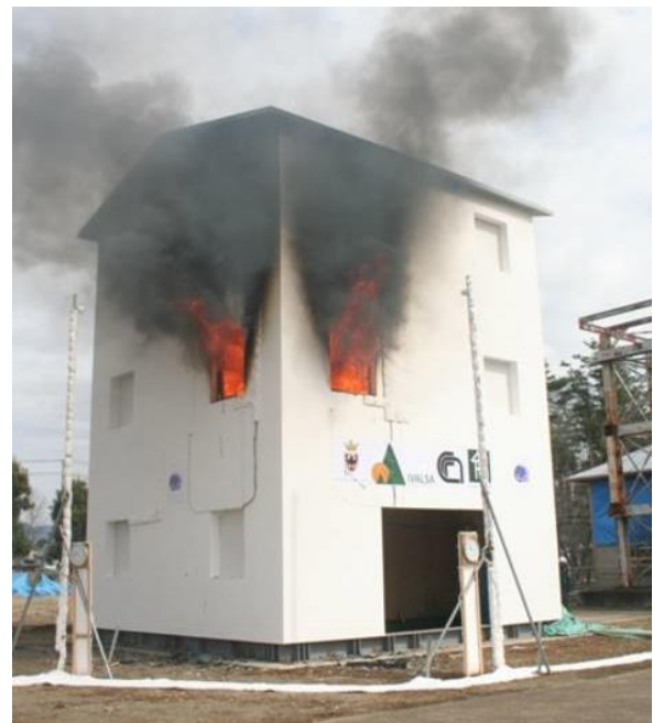
Prova della prestanza anti incendio di una struttura X-LAM - fonte: CNR - IVALSA
