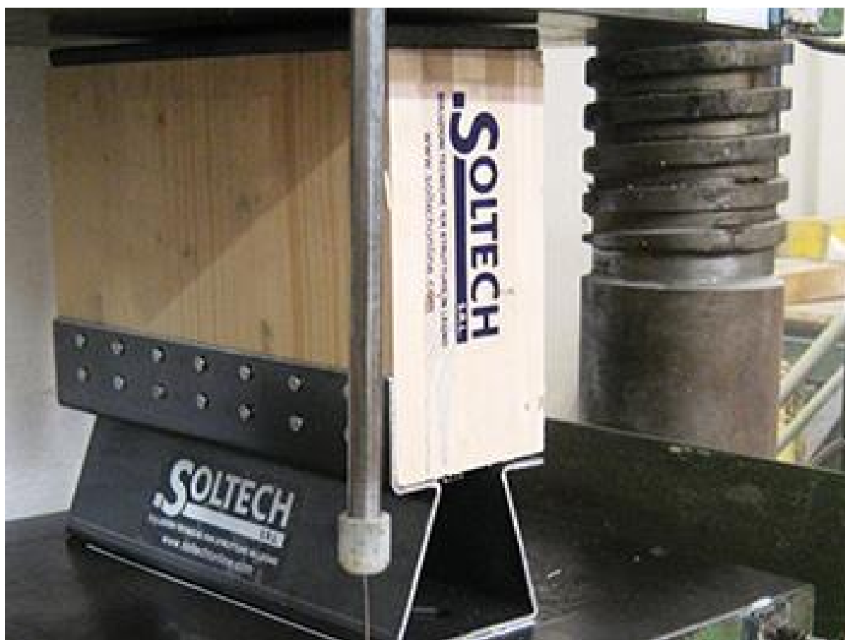
Sistema di ancoraggio ventilato realizzato in acciaio e fissato mediante bullonatura alla base dell'elemento ligneo – fonte: Soltech srl
