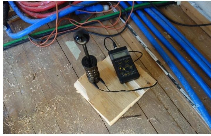
Fasi di taglio e misurazione del livello di umidità presente all'interno del legno che ha subito una riduzione della sua durabilità a causa di infiltrazioni d'acqua per le soluzioni impiantistiche errate adottate – fotografie fornite dal professionista incaricato dei lavori, l'ingegner Franco Piva di Ergodomus
