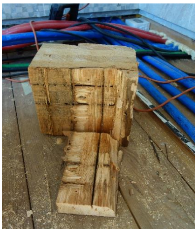
Fasi di taglio e misurazione del livello di umidità presente all'interno del legno che ha subito una riduzione della sua durabilità a causa di infiltrazioni d'acqua per le soluzioni impiantistiche errate adottate – fotografie fornite dal professionista incaricato dei lavori, l'ingegner Franco Piva di Ergodomus
