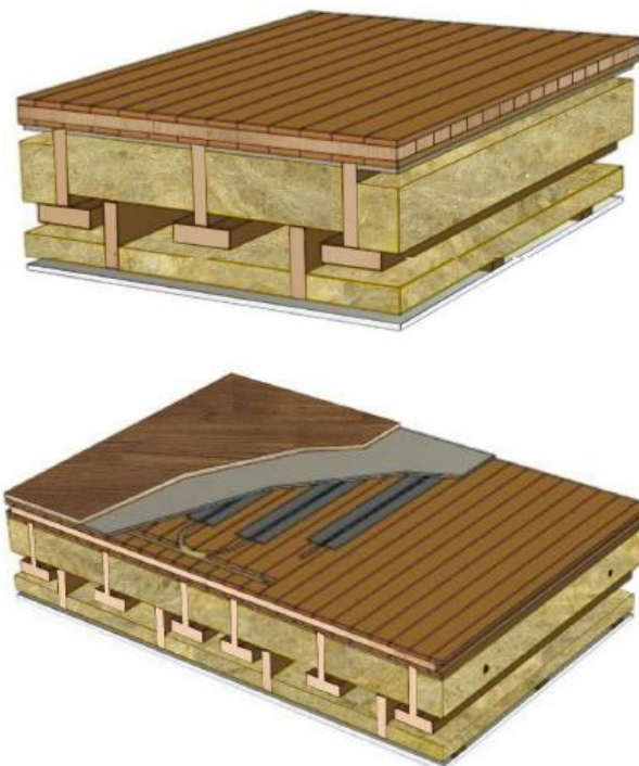
Stratigrafie degli elementi di solaio di partizione orizzontale della struttura dell'edificio e sistema di riscaldamento a pavimento – elaborazione degli autori
