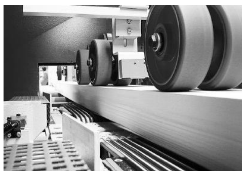
Prova basata su emissione di raggi per misurare la densità di provini di legname – fonte: Wtp.hoechsmann
