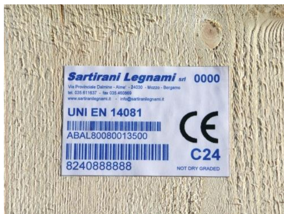
Porzione di elemento ligneo che porta marcatura CE - fonte: Sartirani Legnami
