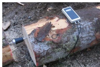
Schema del funzionamento di un sistema a propagazione di onde e strumentazione in funzione su un tronco appena tagliato
