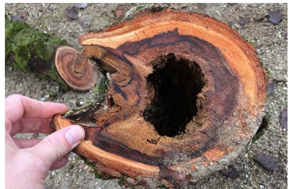
Tronco compromesso a causa di attacco da carie bruna – fonte: Infobuild
