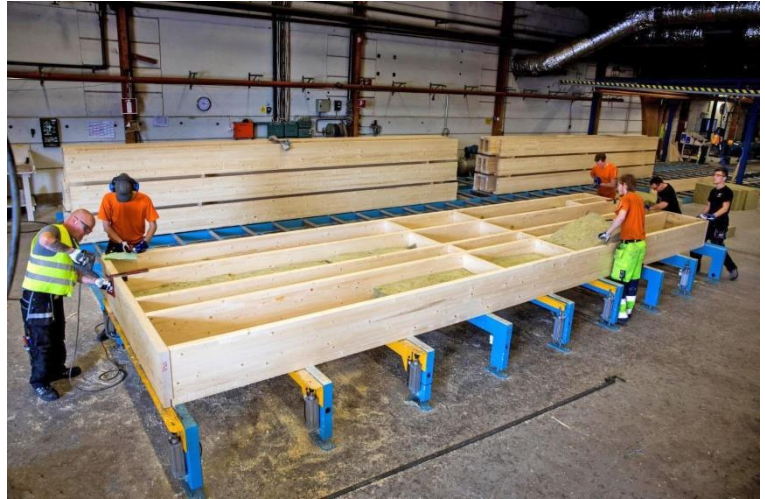
Elementi prefabbricati della facciata nello stabilimento di produzione completi di isolante e rivestimento esterno
