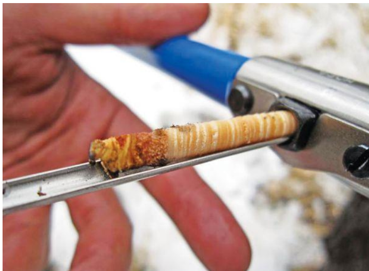
Sistema di microcarotaggio: prelievo di piccole carote da elementi strutturali in legno – fonte: StrumentiForestali
