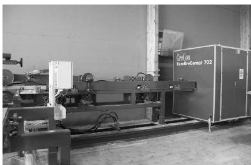
Prova basata su emissione di raggi per misurare la densità di provini di legname – fonte: Wtp.hoechsmann
