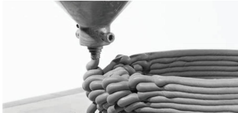
*Estrusione della ceramica dall'ugello della stampante 3D - corriere.it - 8 Giugno 2018*
