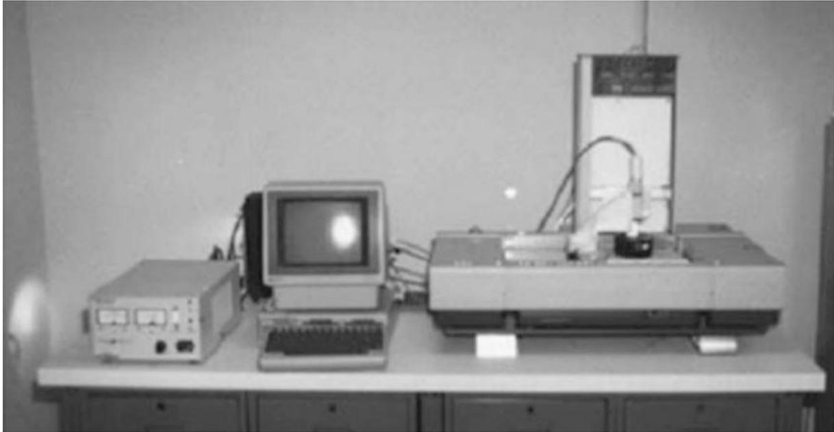
Figura 1: Apparato per Stereolitografia ideato da Hull, fondatore di 3D Systems [3]
