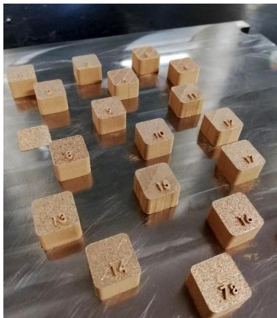
Figura 53: Campioni in bronzo realizzati su piattaforma in acciaio, dopo la rimozione della polvere non processata
