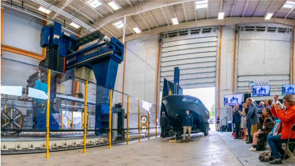
Figura 9: Il sistema dell'Università del Maine per "stampa 3d" a base polimerica e barca realizzata con esso [17].
