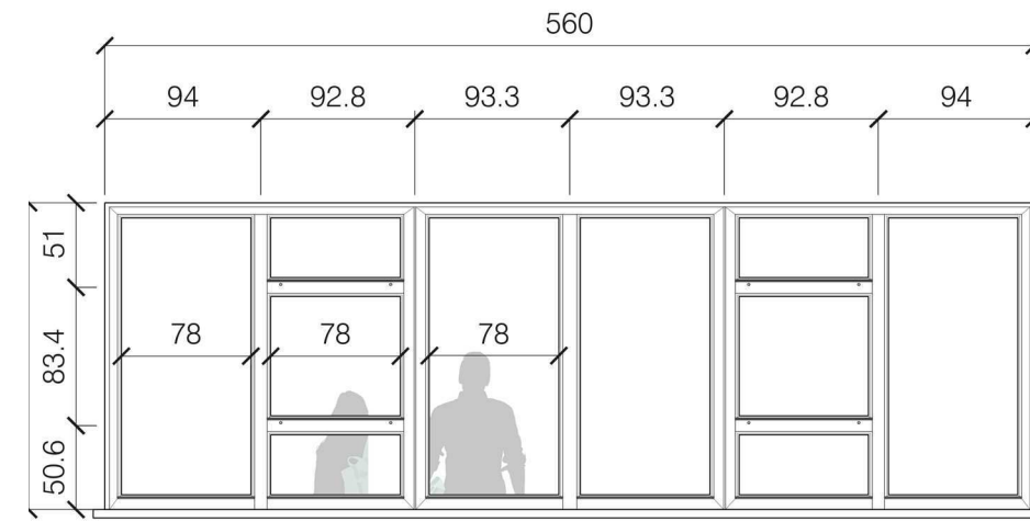
DETTAGLIO FINESTRA 39: VISTA DALL'ESTERNO_Scala 1:50
