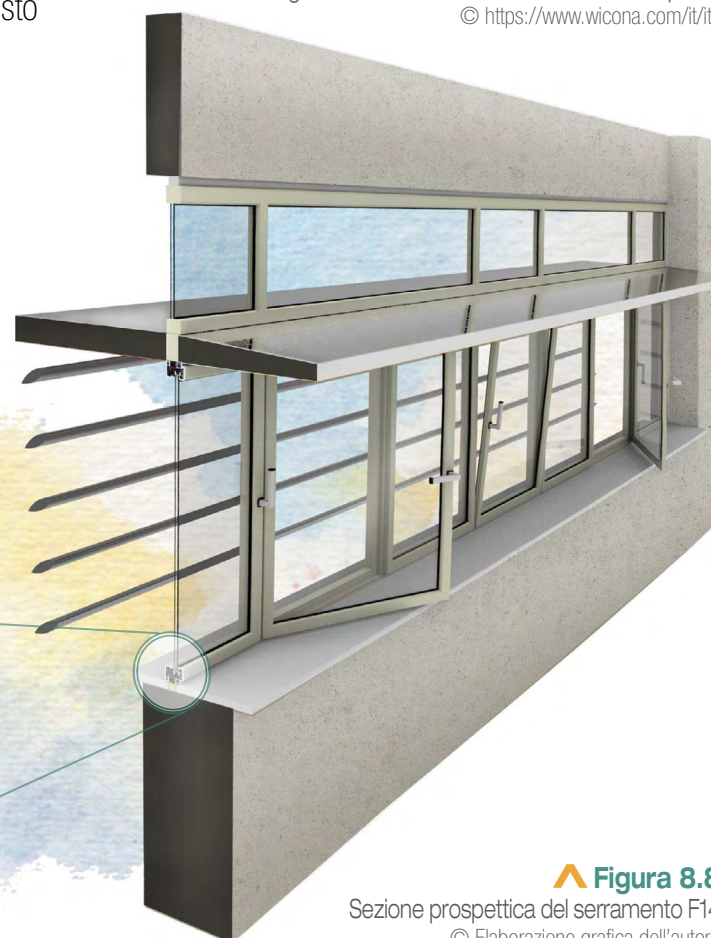
Figura 8.9 Dettaglio serramento WICONA con anta a scomparsa © https://www.wicona.com/it/it/
