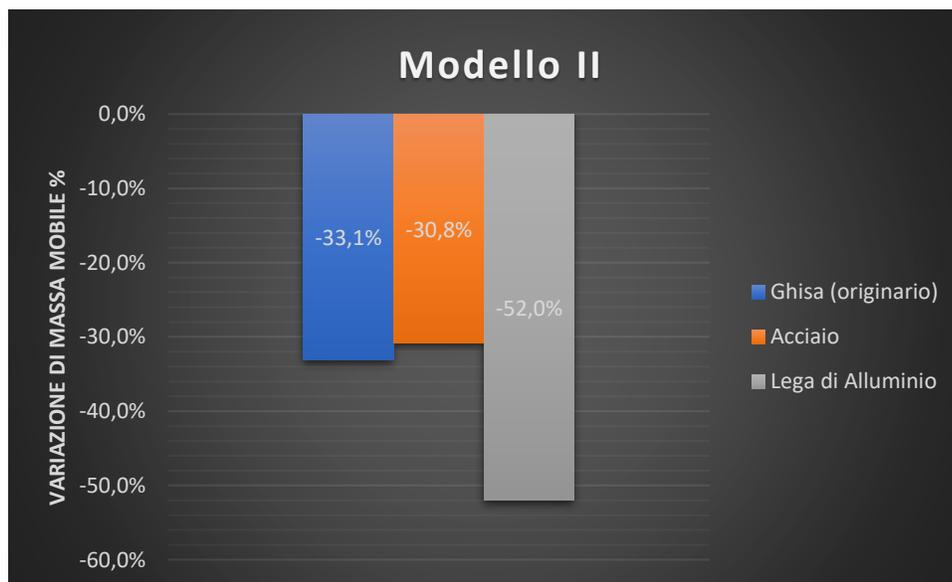
Figura 8.3 Rappresentazione grafica della variazione di massa mobile dell'asse Z
