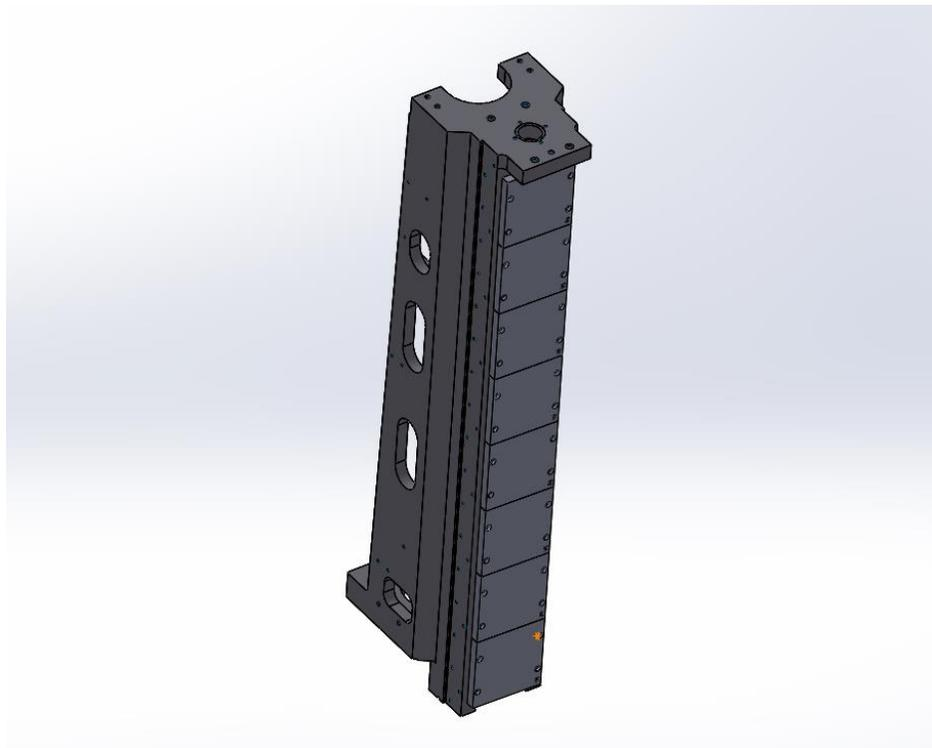
*Figura 5.1 Rappresentazione CAD carro mobile Modello I*
