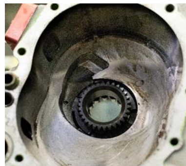
Figura 3-10 Modifica della cassa statorica
