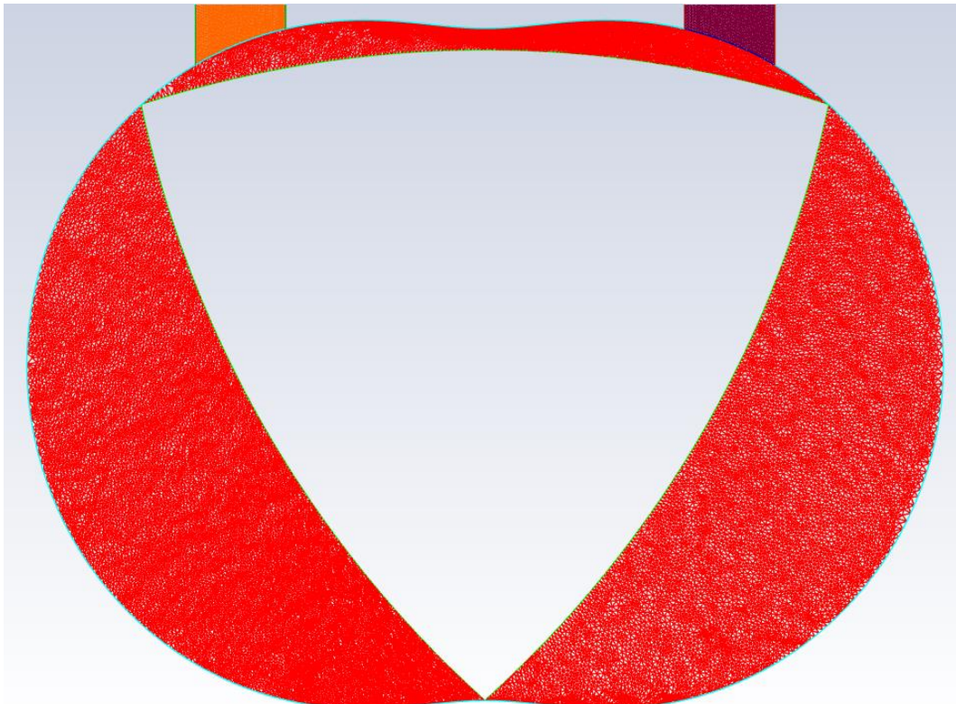
Figura 5.18: Deformazione mesh dopo 6'000 time step
