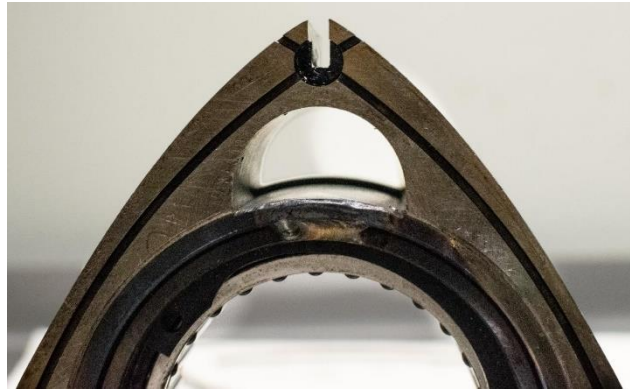
Figura 3.21: Sede scavata nel rotore in cui vengono montati gli apex e gli anelli di tenuta
