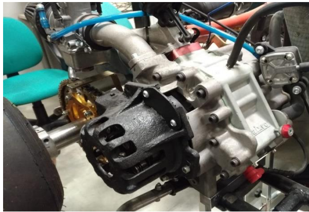
Figura 3.1: Motore Wankel montato fissato sul telaio del kart
