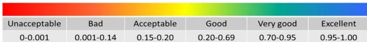
Figura 5.7: Banda di valori della Skewness e della Orthogonal quality [37]
