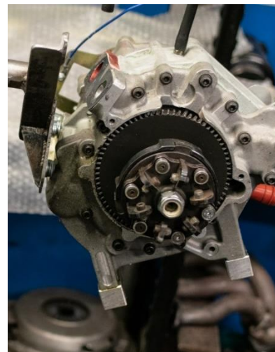
Figura 3.8: Doppia luce di aspirazione, una periferica (contorno rosso) e una laterale
