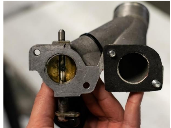
Figura 3.10: Particolare della valvola a farfalla nel collettore di aspirazione
