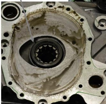
Figura 3.11, 3.12 e 3.13: Le immagini mostrano il percorso fatto dal fluido entrante dalla luce laterale
