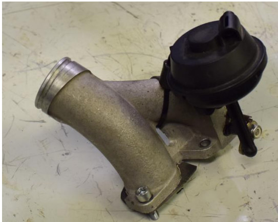
Figura 3.9: Vista dall'alto del collettore di aspirazione
