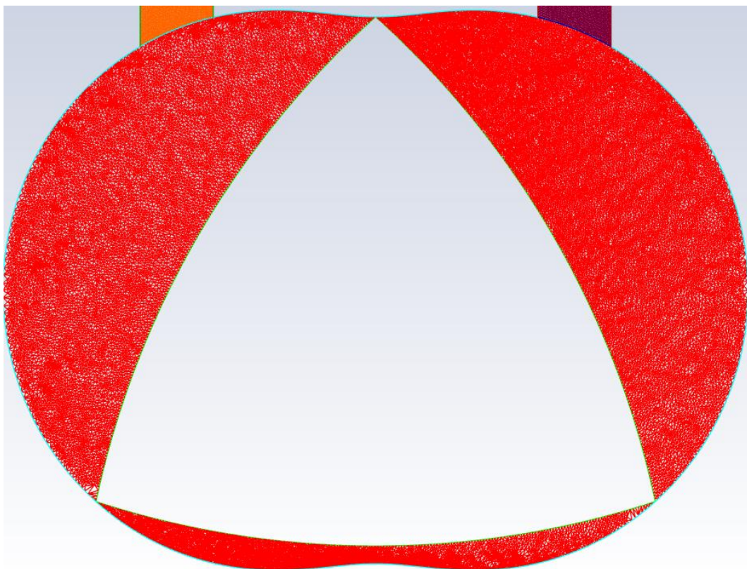
Figura 5.20: Deformazione mesh dopo 18'000 time step
