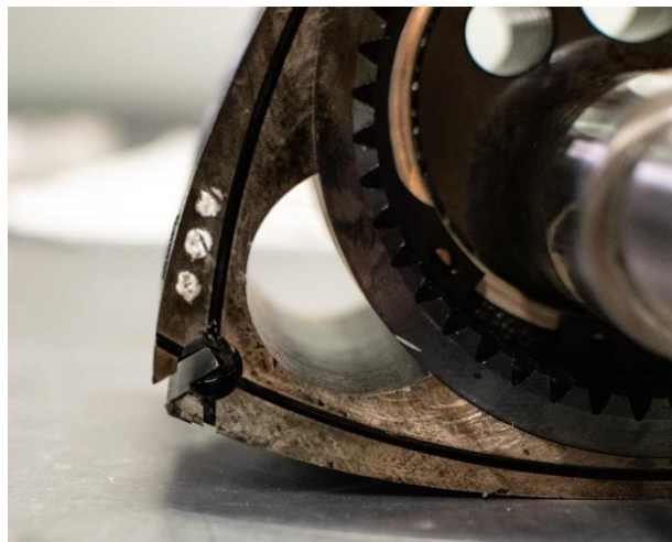
Figura 3.17: Immagine di dettaglio del rotore, si nota la ruota dentata a denti interni solidale al rotore
