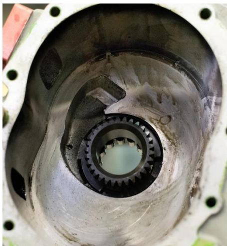
Figura 3.16: Al centro della foto si nota il pignone statorico
