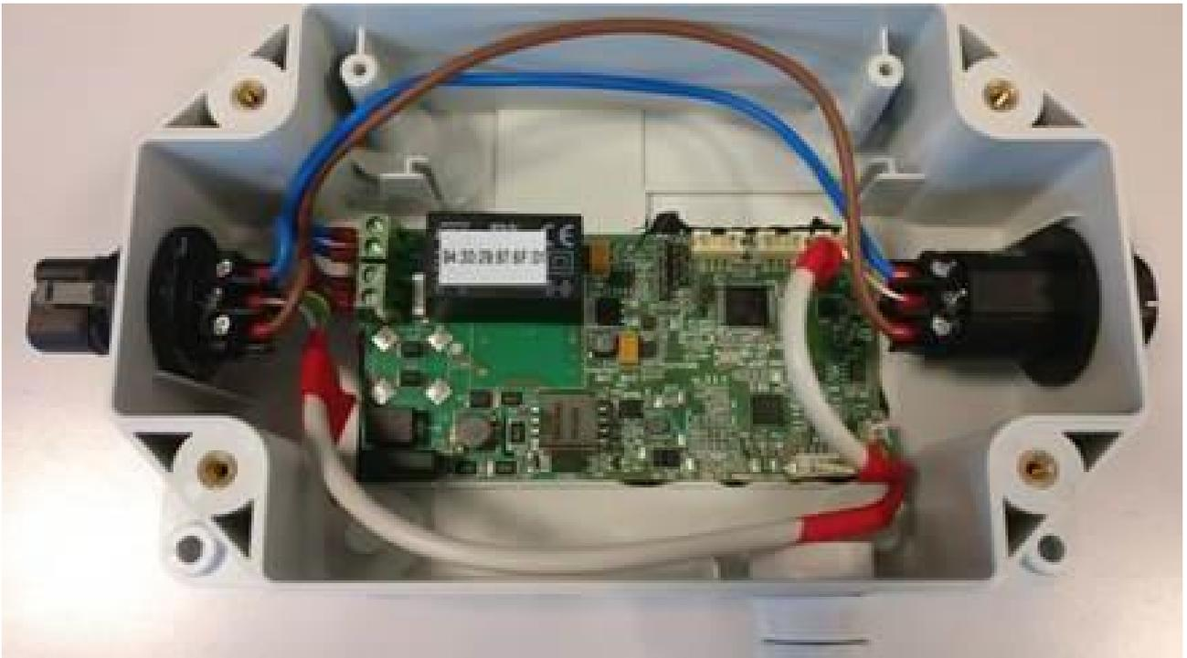
Figura 1.6 Foto dell'inclinometro utilizzato con cablaggio
