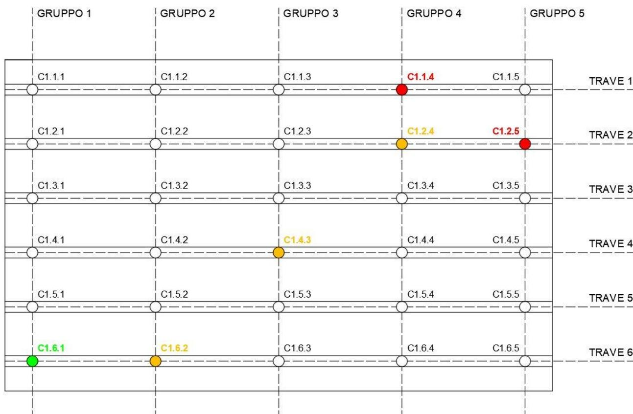
Figura 3.30 Pianta della campata con i sensori anomali segnalati
