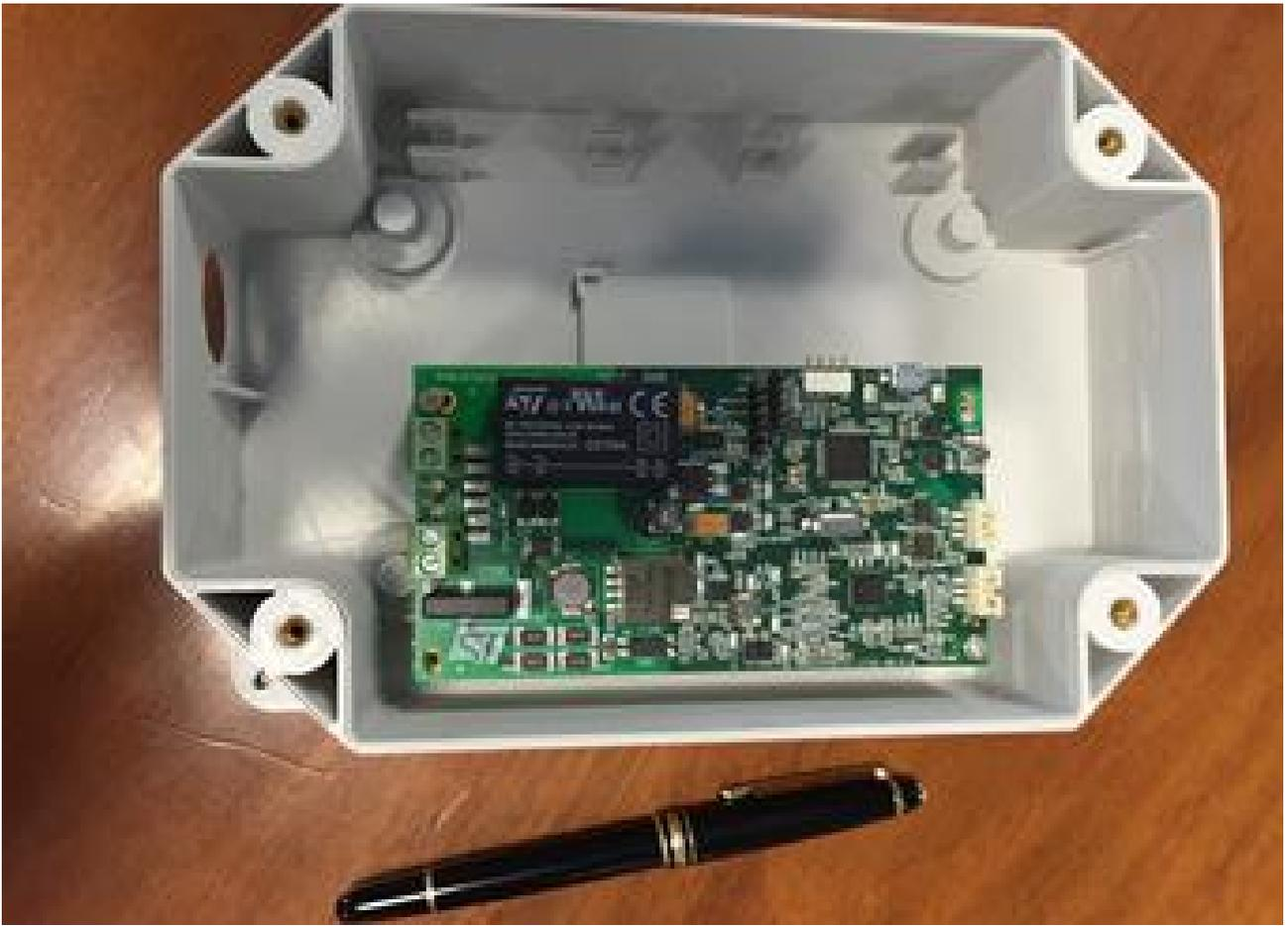
Figura 1.5 Foto dell'inclinometro utilizzato senza cablaggio
