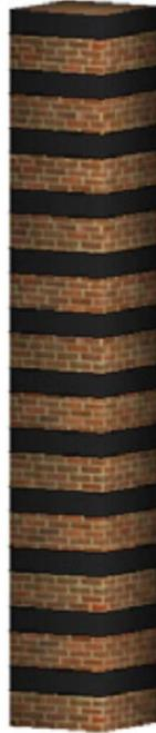
Figura 4. 19: confinamento di una colonna in muratura [21]
