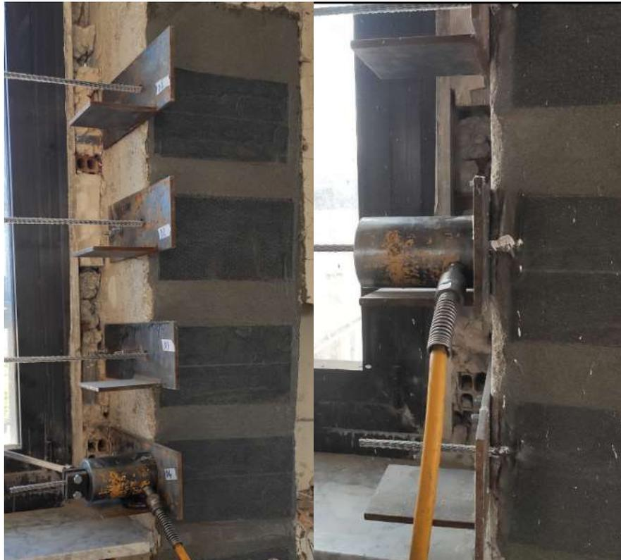
*Figura 4. 47 prova di scorrimento su fasce in C-FRP*
