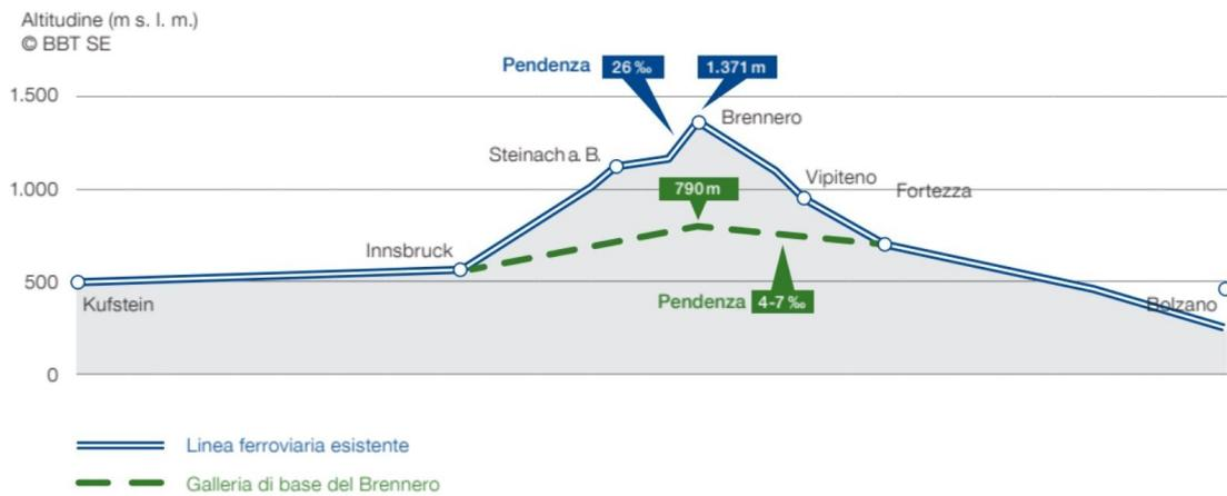
Figura 1.5 - Sezione longitudinale della Galleria di Base del Brennero [www.bbt-se.com]
