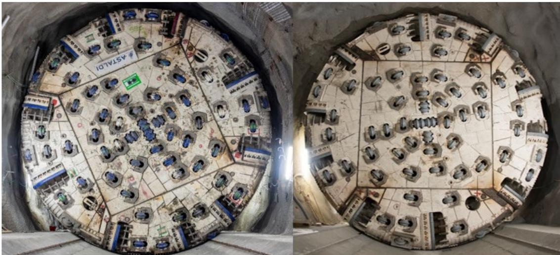
Figura 3.9 - A sinistra testa fresante della DS-TBM "Virginia". A destra testa fresante della DS-TBM "Flavia". [BBT-SE]
