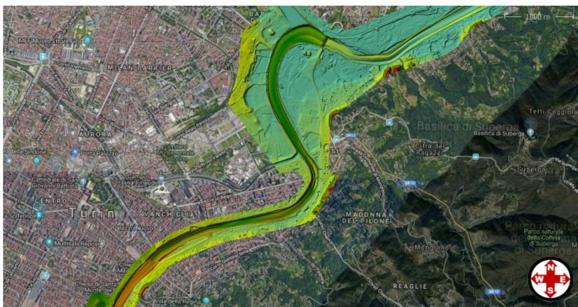
Fig. 9 - Stralcio DTM interpolato con la batimetria
