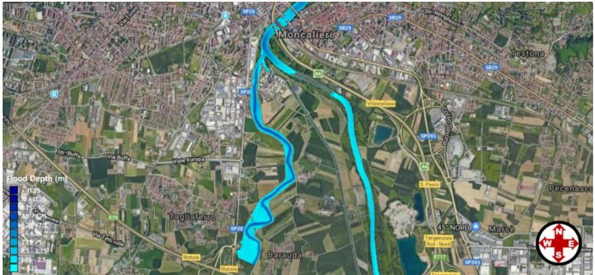
Fig. 75 - Scenario con Portata nel Chisola riferita a TR200
