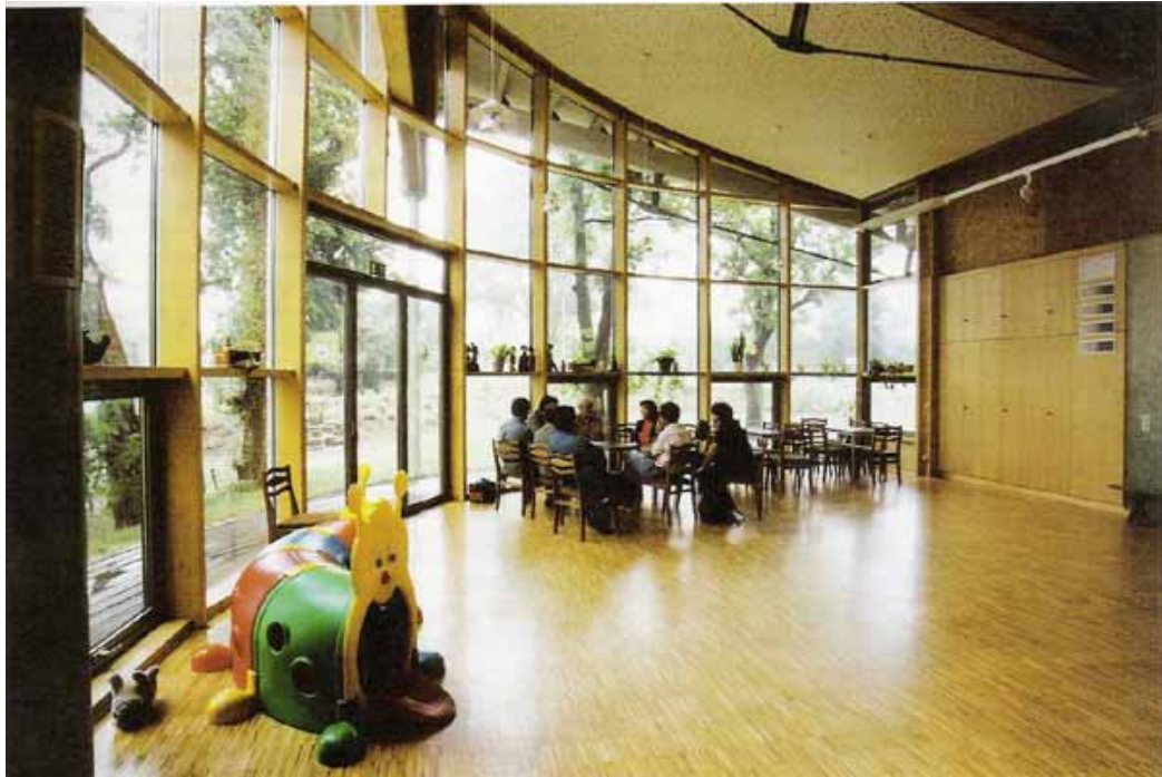
Asilo Trinitatis a Riesa, Germania. Vista dell'atrio vetrato polifunzionale con pavimento in legno trattato con vernice a base di sapone gommalacca, atossico e facilmente lavabile
