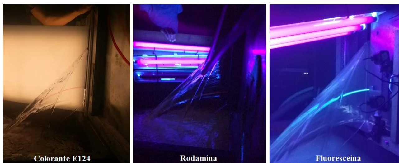
Figura 5.42 - Visibilità della vena capillare relativa all'utilizzo di diverse sostanze
