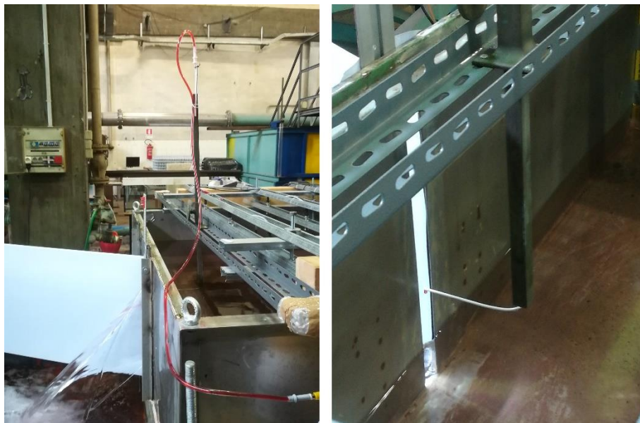
Figura 5.36 – A sinistra, set-up del tubo capillare; a destra, vista della breccia e del tubo capillare dall'interno del serbatoio
