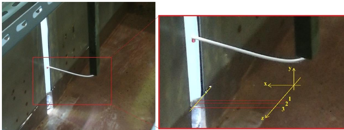
Figura 5.44 - Rappresentazione delle diverse posizioni assunte dall'iniettore nella direzione perpendicolare al flusso
