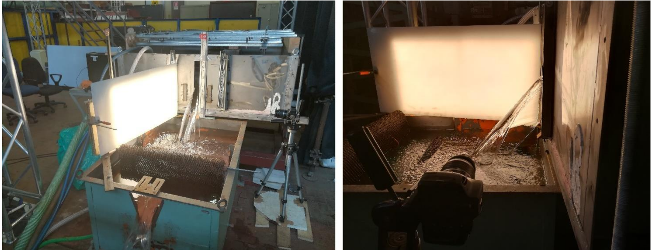
Figura 5.7 – Rappresentazione del set-up sperimentale durante l'esecuzione di un esperimento. A destra si può osservare la vena fluida dal punto di vista della fotocamera
