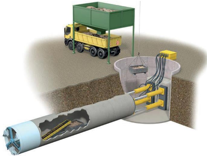
Figura 14: Tipica disposizione per scavo in spingitubo [14]
