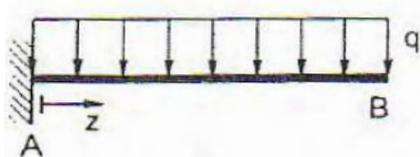
Figura 5.1.10 - Schema strutturale di mensola lunga  $l$ , con carico distribuito uniforme
