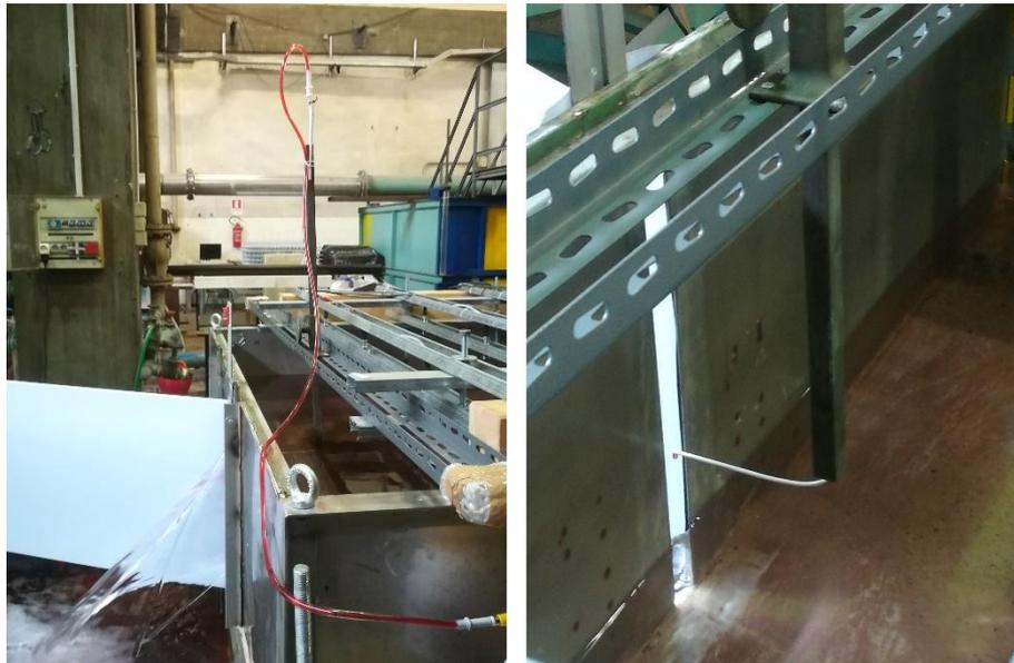
Figura 3.36 – A sinistra, set-up del tubo capillare; a destra, vista della breccia e del tubo capillare dall'interno del serbatoio
