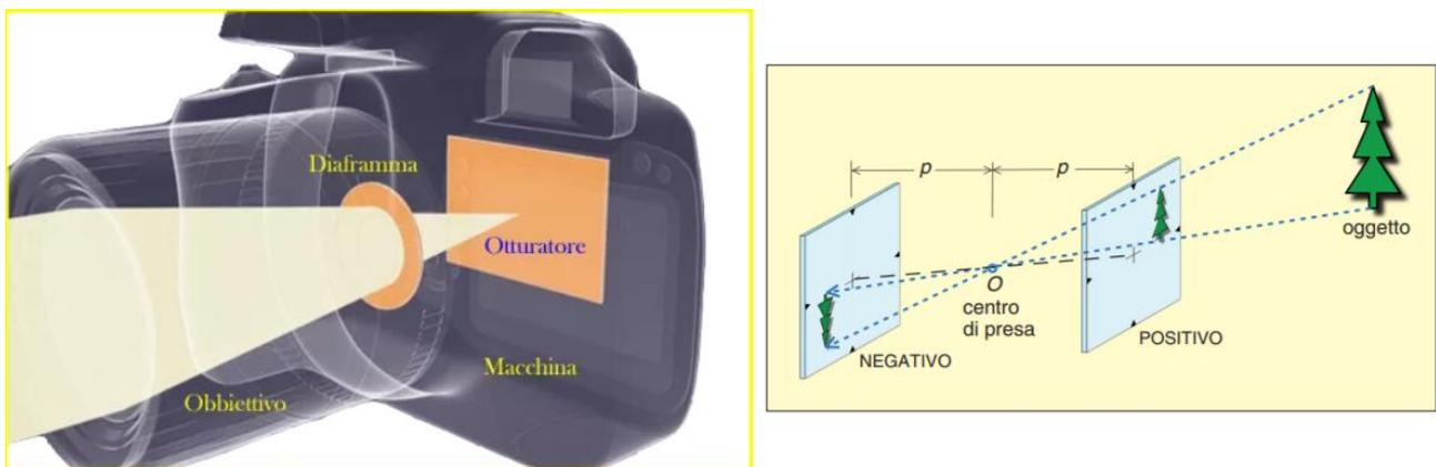
*Figura 3.12 – Percorso della luce all'interno dell'obiettivo e della fotocamera. Sia il diaframma che l'otturatore determinano la quantità di luce che arriva al sensore. A destra, uno schema della geometria della presa fotografica*
